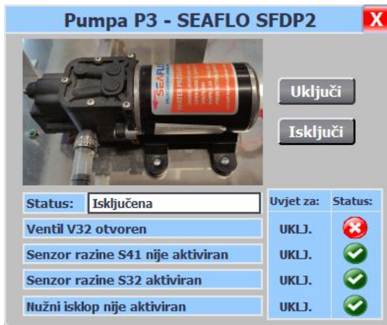
Slika 6.5 Prikaz faceplate -a unutar HMI ekrana upravljanje
