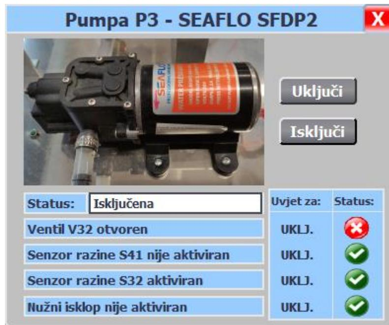
Slika 6.5 Prikaz *faceplate*-a unutar HMI ekrana upravljanje
