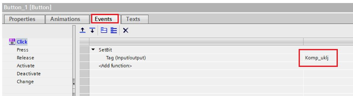
Slika 6.12 Postavljanje event-a za uključivanje komponente (Button\_1)
