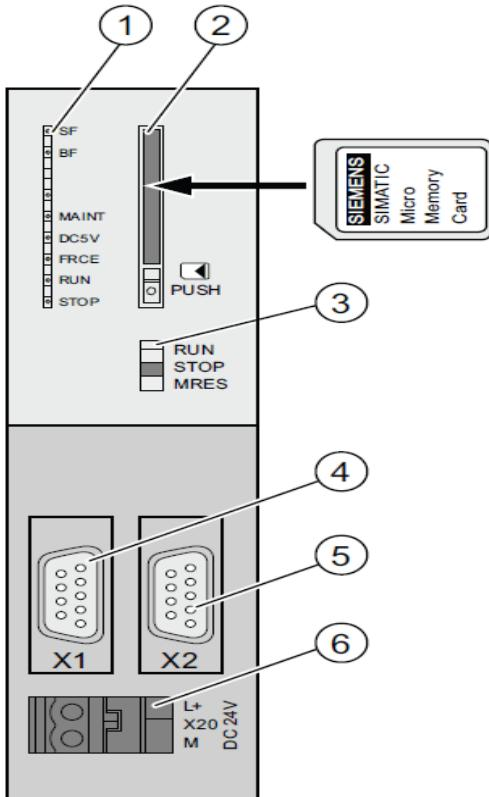
Slika 2.7 Shematski prikaz CPU-a 315-2 DP [3]
