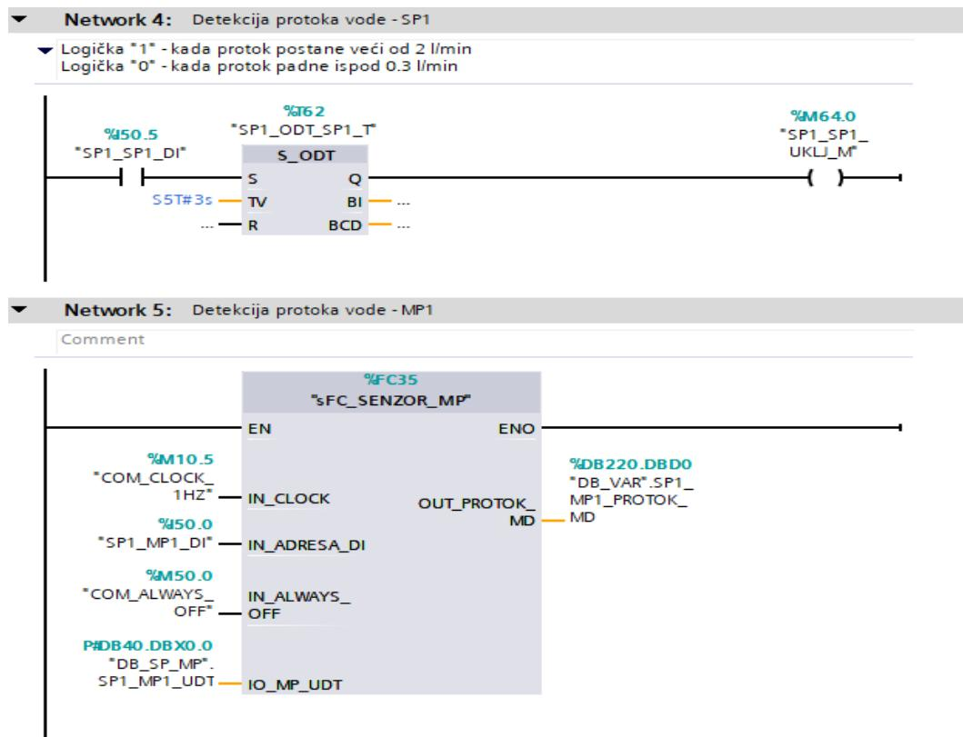
Slika 4.10 Detekcija protoka vode senzora SP1 i MP1
