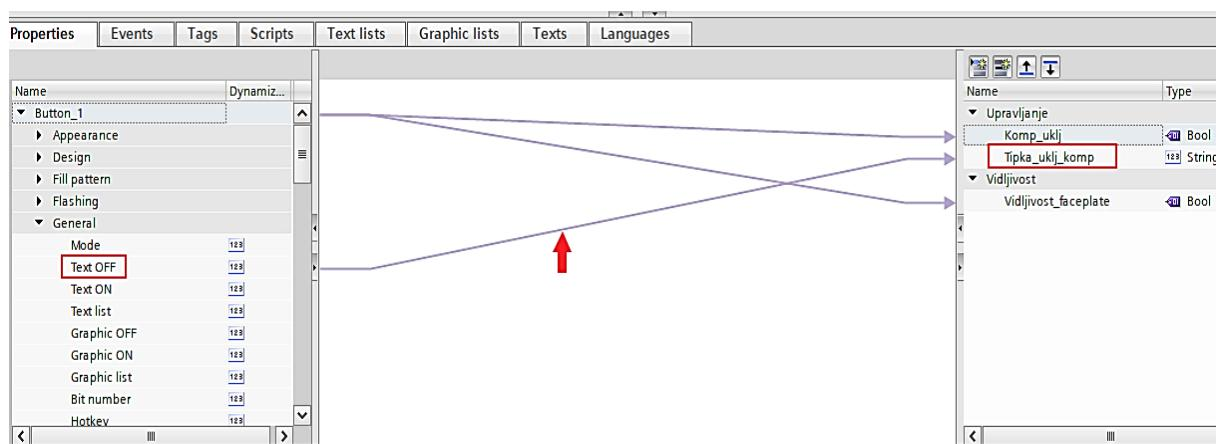
Slika 6.10 Povezivanje svojstava dugmeta za uključivanje komponente (Button\_1)
