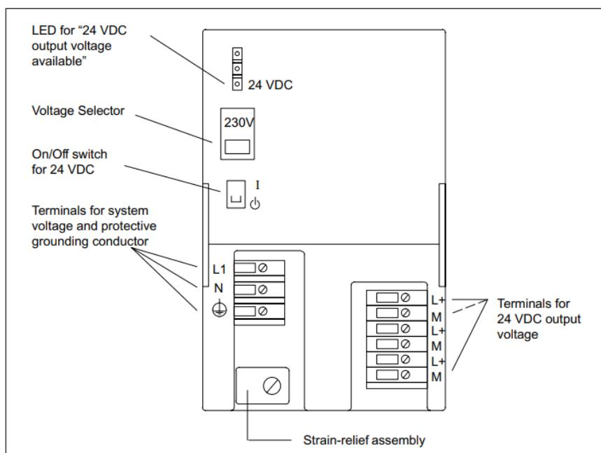
Slika 2.6 Shema ožičenja modula napajanja PS 307 5A [2]
