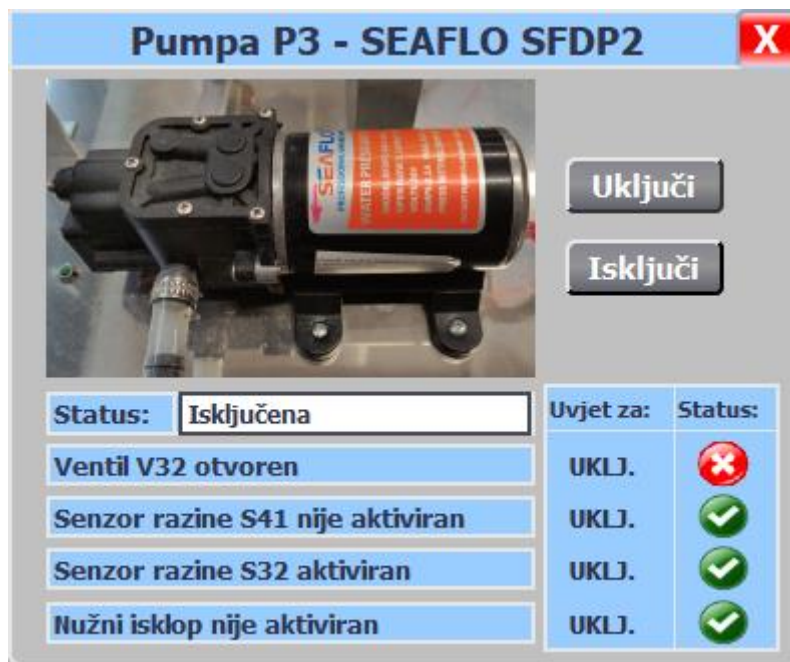
Slika 6.5 Prikaz faceplate -a unutar HMI ekrana upravljanje
