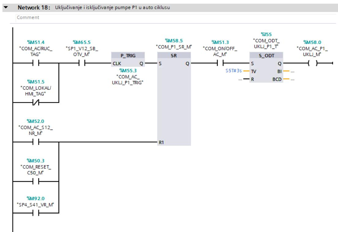
Slika 4.6 Uključivanje i isključivanje pumpe P1 u auto ciklusu
