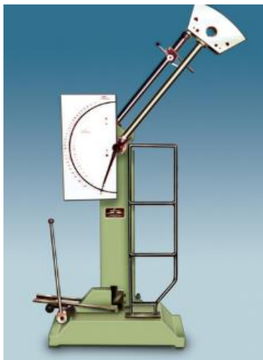
Slika 1.7 Prikaz Izodovog uređaja za ispitivanje žilavosti [4]
