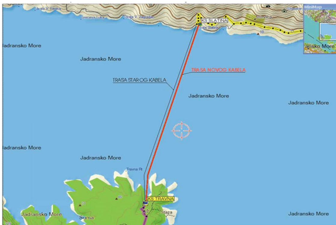
Slika 3.1. Postojeći podmorski kabel od KS Slatina do KS Travnica
