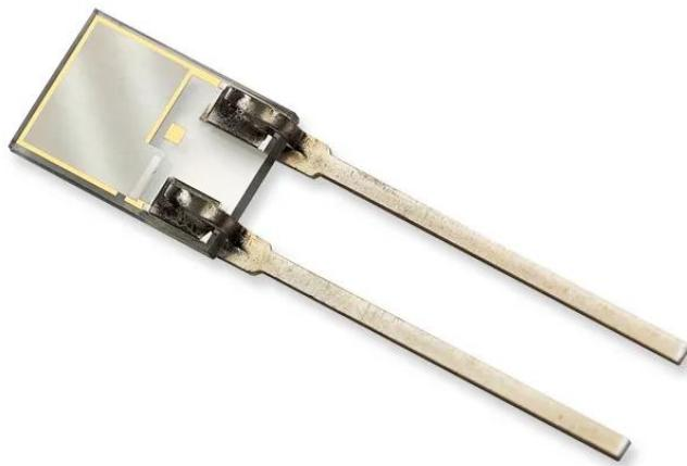
Slika 10. Kapacitvni senzor vlažnosti tla [20]
