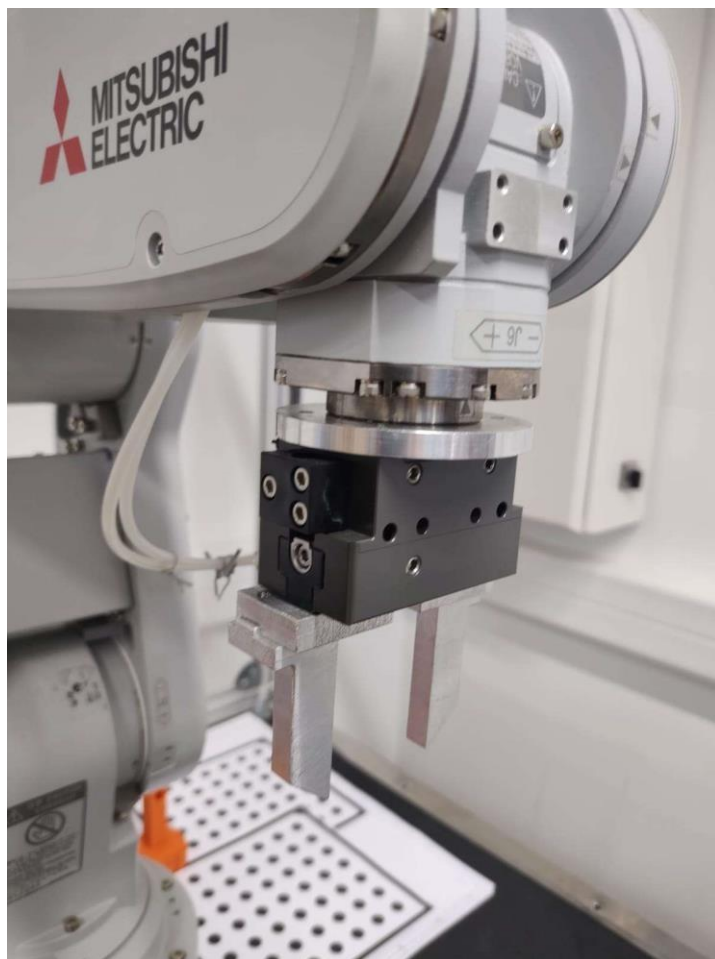
Slika 2.4 Gripper na robotu u laboratoriju
