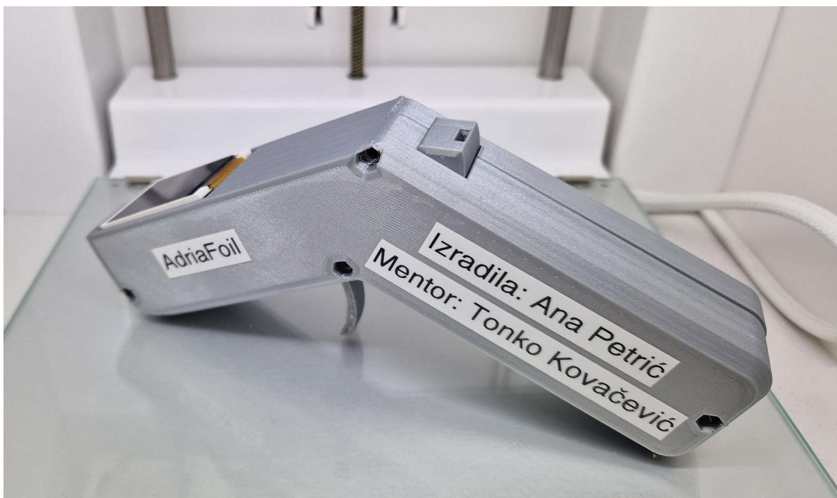
Slika 1.1. Završeni prototip daljinskog upravljača
