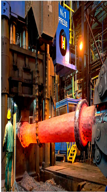
Slika 1.1- Proces slobodnoga kovanja osovine iz sirovca na hidrauličkoj presi [3]
