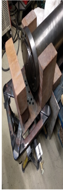
Slika 4.5- Izgradnja peći oko osovine i priubnice
