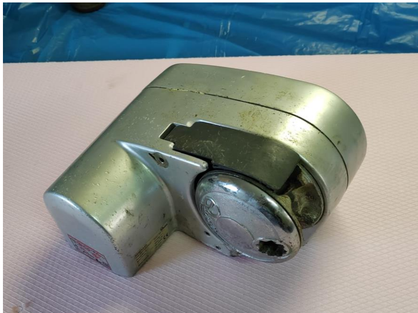
Slika 1.4-Quick G1000 električno sidreno vitlo
