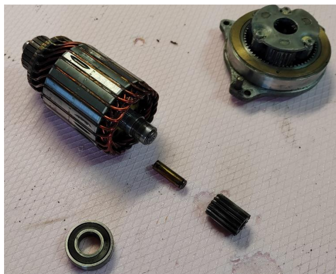
Slika 2.3-Rotor elektromotora s odlomljenim rukavcem
