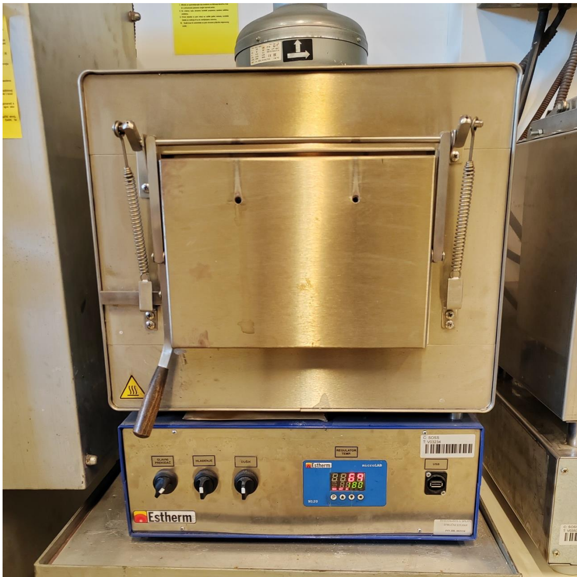
Slika 4.10-Nisko temperaturno popuštanje vratila
