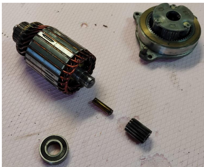
Slika 2.3-Rotor elektromotora s odlomljenim rukavcem
