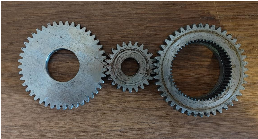
Slika 3.1-Pogonski, gonjeni i među zupčanik
