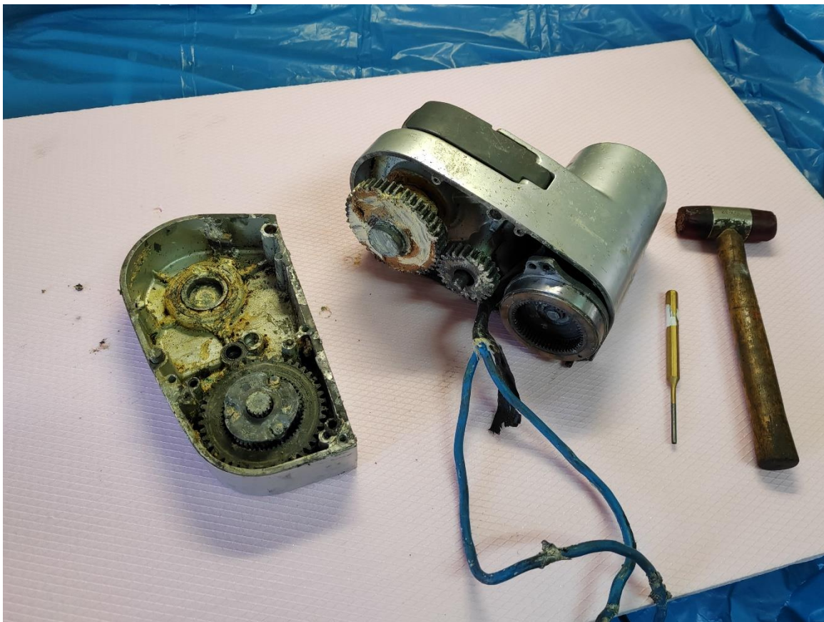
Slika 2.1-Vitlo nakon uklonjenog poklopca
