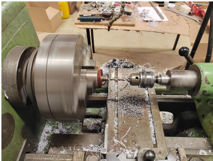
Slika 2.5-Bušenje prednjeg rukavca ležaja
