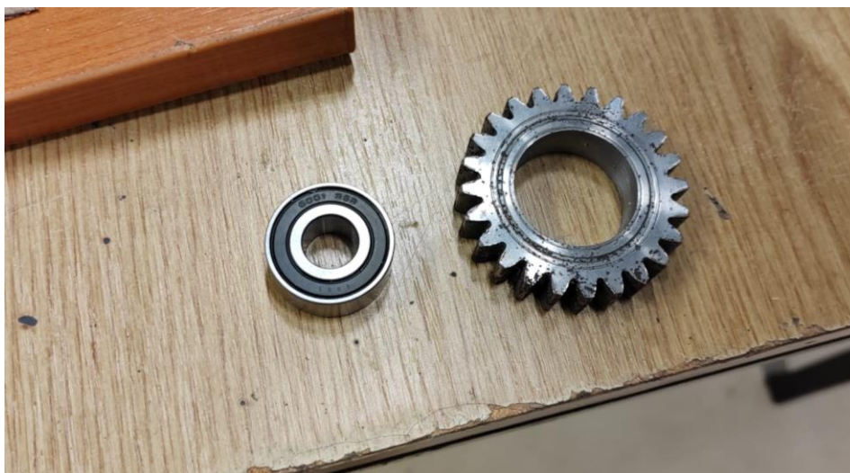
Slika 4.14-Zupčanik prilagođen za novi ležaj
