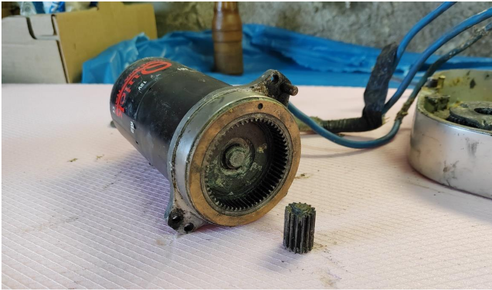
Slika 2.4-Mjesto loma na pogonskom vratilu
