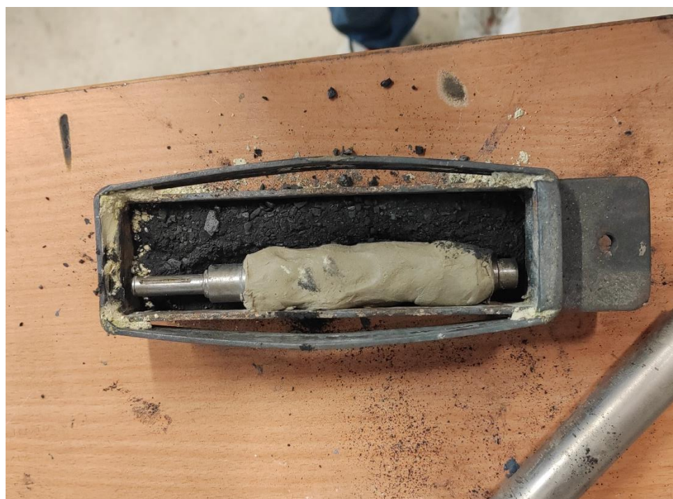
Slika 4.8-Vratila u kutiji za cementiranje
