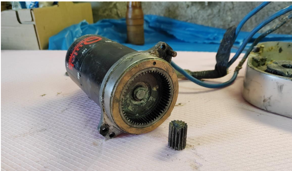
Slika 2.4-Mjesto loma na pogonskom vratilu
