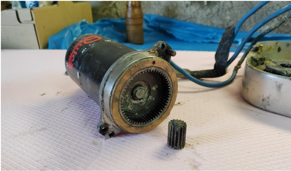
Slika 2.4-Mjesto loma na pogonskom vratilu
