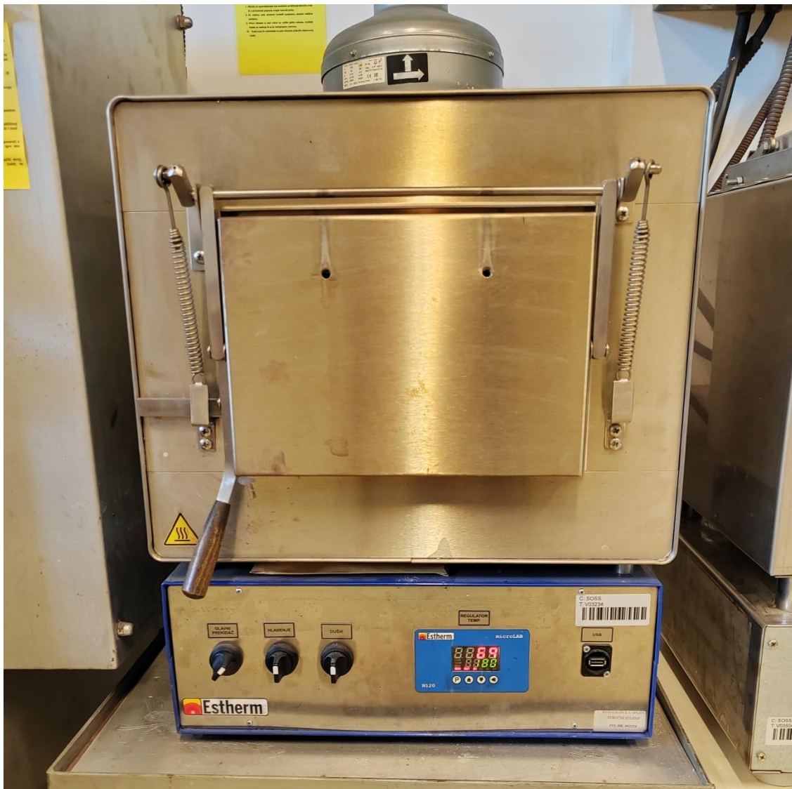
Slika 4.10-Nisko temperaturno popuštanje vratila
