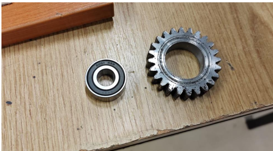
Slika 4.14-Zupčanik prilagođen za novi ležaj
