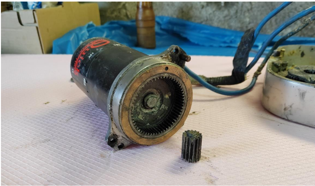
Slika 2.4-Mjesto loma na pogonskom vratilu
