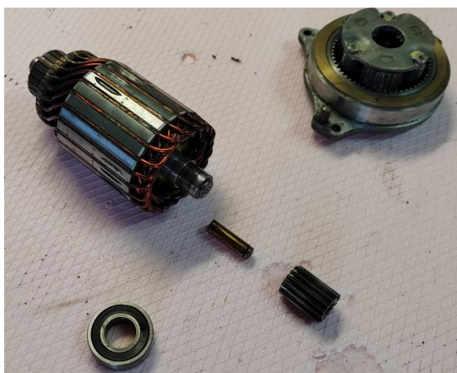
Slika 2.3-Rotor elektromotora s odlomljenim rukavcem
