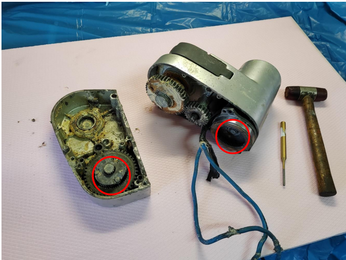
Slika 2.2-Zupčanik odvojen od vratila
