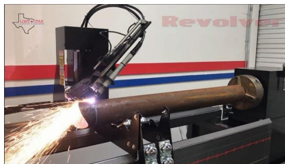
Slika 2.4 – CNC uređaj za obradu cijevi [4]
