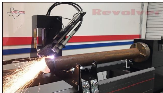
Slika 2.4 – CNC uređaj za obradu cijevi [4]
