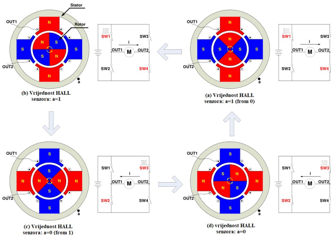
Slika 2.6 Sekvenca komutacije monofaznog BLDC motora [1]
