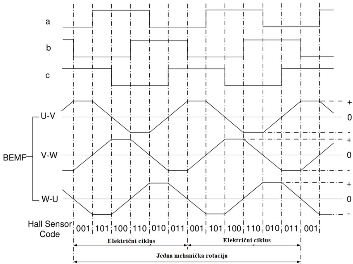
Slika 2.10 Usporedba izlaza Hall senzora i BEMF signala[1]
