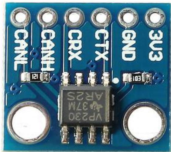
Slika 6.7. SN65HVD230 primopredajnik
