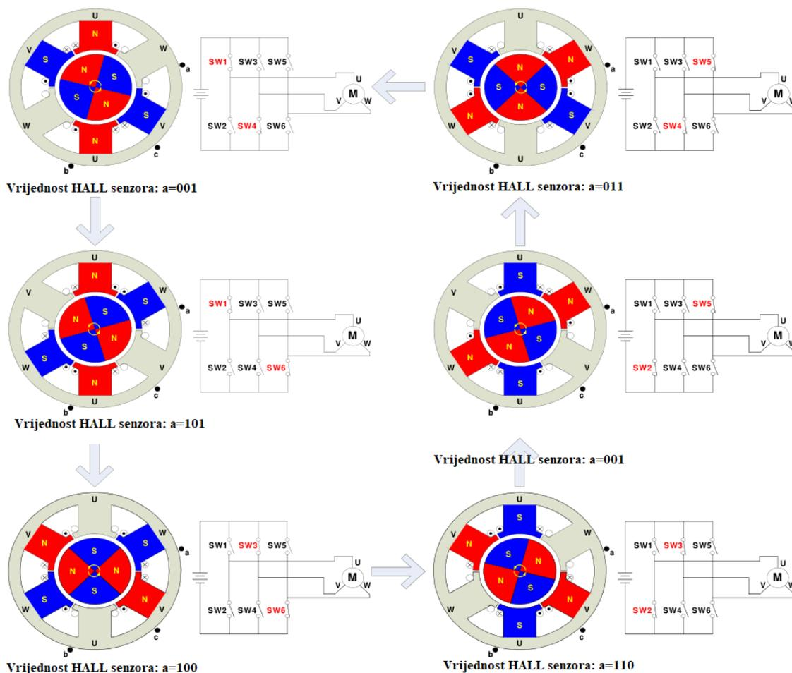
Slika 2.8 Sekvenca komutacije trofaznog BLDC motora [1]
