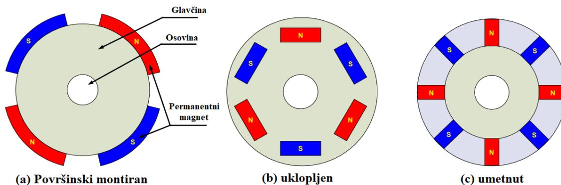
Slika 2.2 Poprečni presjek magneta na rotoru [1]
