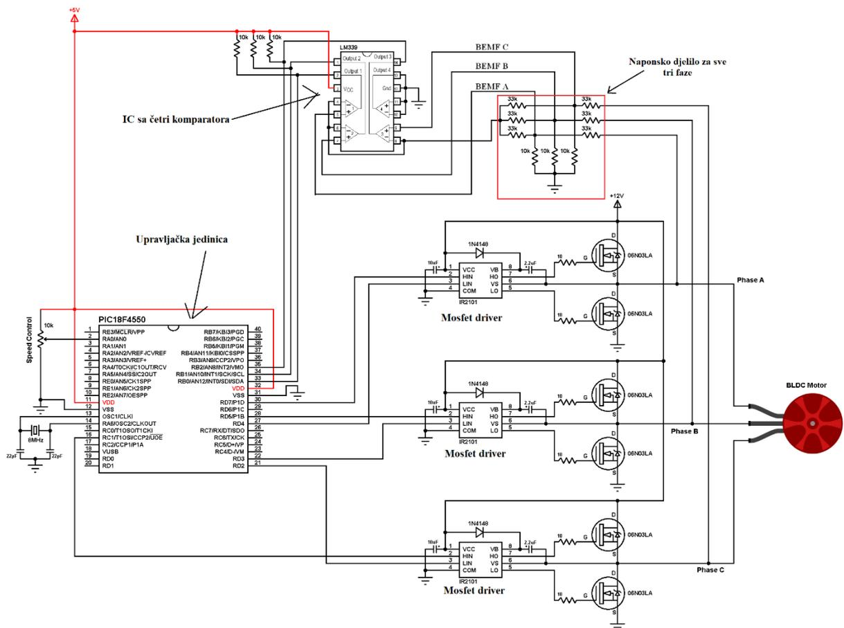
Slika 2.11 Shema upravljanja BLDC motorom bez senzora[3]
