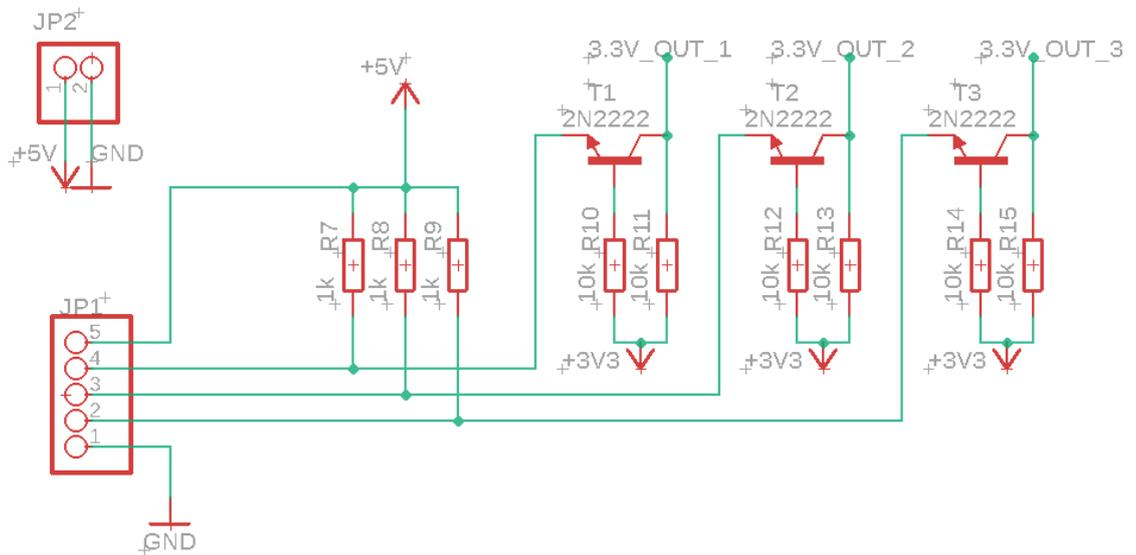
Slika 6.5 Shema pretvarača logike za 3 hall senzora
