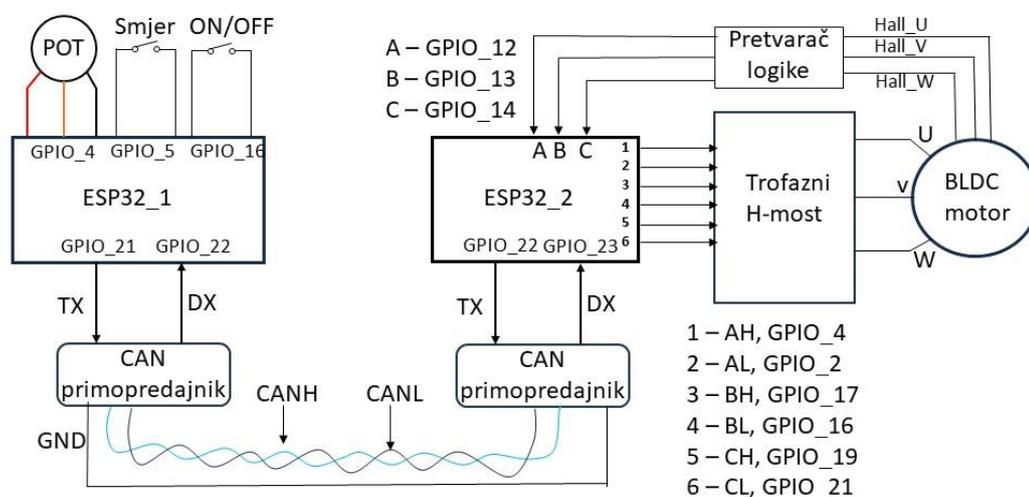
Slika 6.1 Blok shema sustava upravljanja BLDC motorom preko CAN\_BUS protokola
