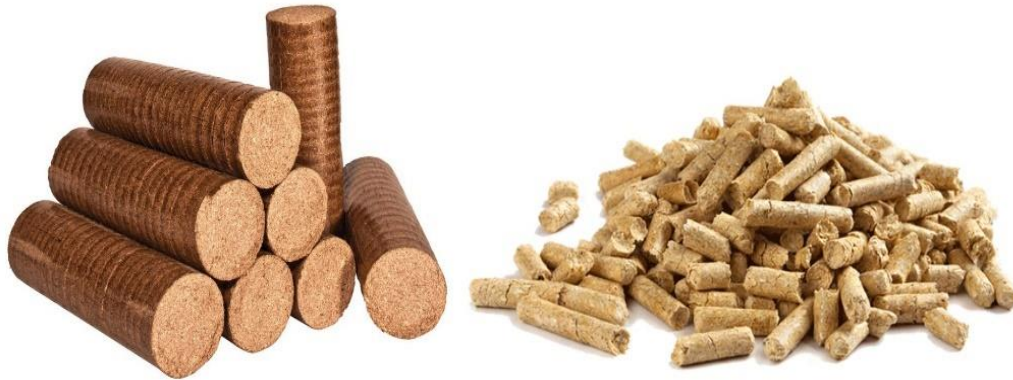
Slika 2.2 - Briketi i peleti [4]
