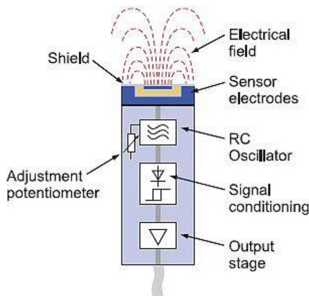
Slika 8.7 – Princip rada kapacitivnog senzora [41]
