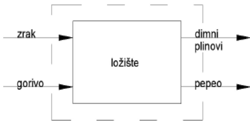
Slika 2.4 - Sudionici i produkti izgaranja unutar ložišta [9]
