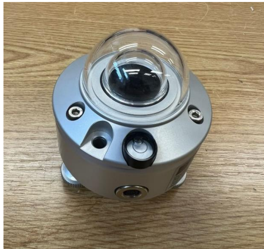
Slika 7.1. Piranometar SMP 10-A
