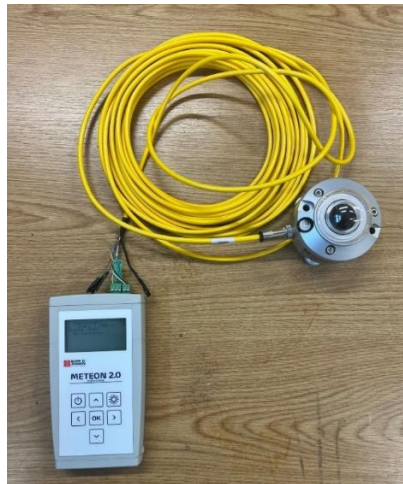
Slika 7.4. Povezivanje SMP 10-A sa Meteon 2.0
