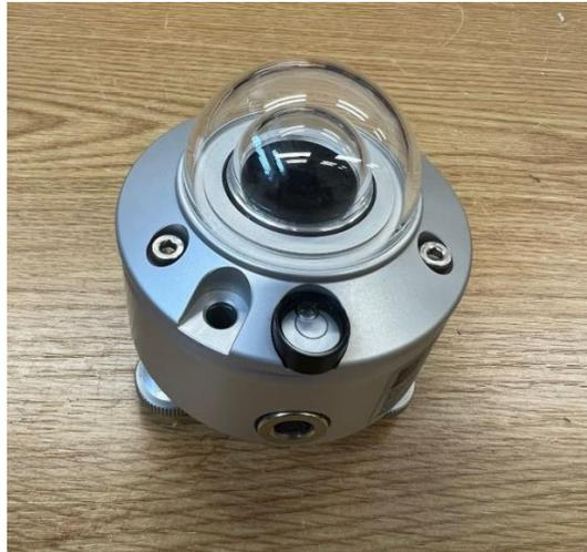
Slika 7.1. Piranometar SMP 10-A
