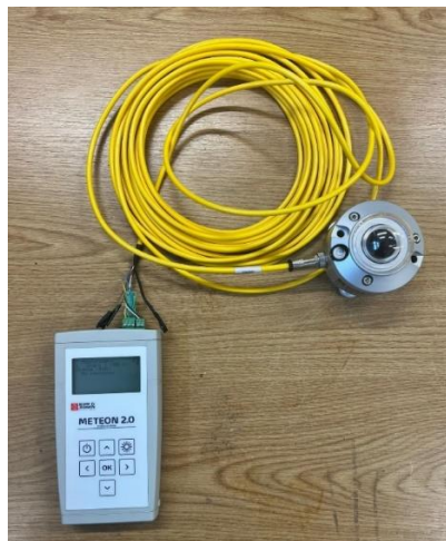
Slika 7.4. Povezivanje SMP 10-A sa Meteon 2.0
