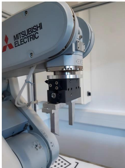
Slika 2.5: Hvataljka robota, izvor: izrada autora
