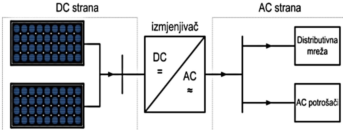
Slika 4.2. Shematski prikaz fotonaponske mrežne elektrane [18]
