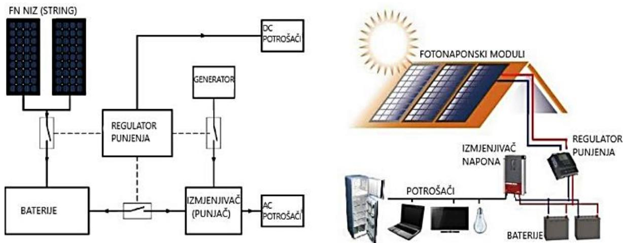
Slika 4.6. Osnovni dijelovi otočne fotonaponske elektrane [21]
