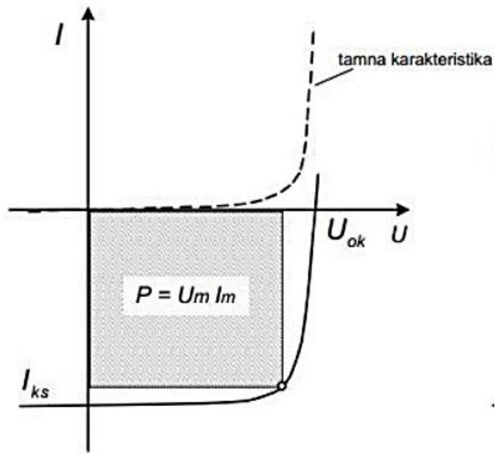
Slika 3.4. Strujno-naponska karakteristika osvjetljenje i ne osvijetljene fotonaponske čelije
