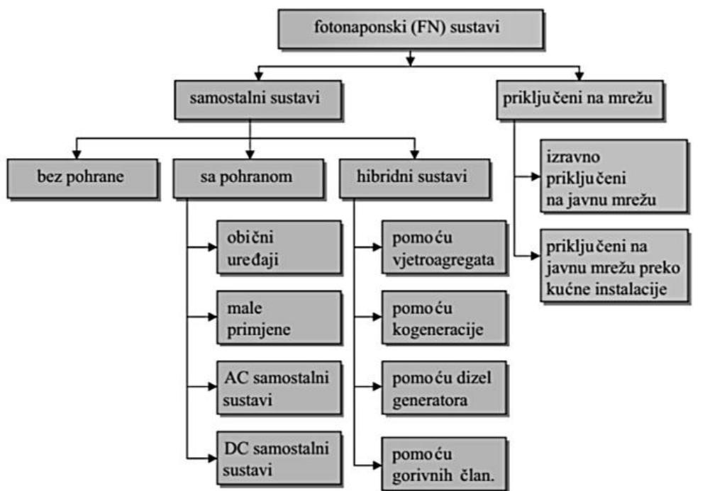
Slika 4.1. Klasifikacija fotonaponskih sustava [17]
