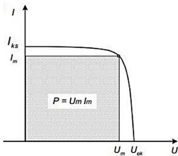
Slika 3.5. Strujno-naponska karakteristika fotonaponske čelije [16]
