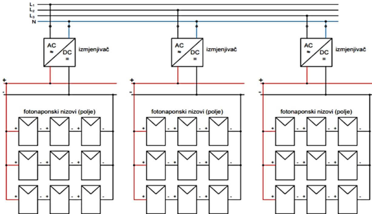
Slika 4.5. Izvedba fotonaponske elektrane koja ima više izmjenjivača [20]
