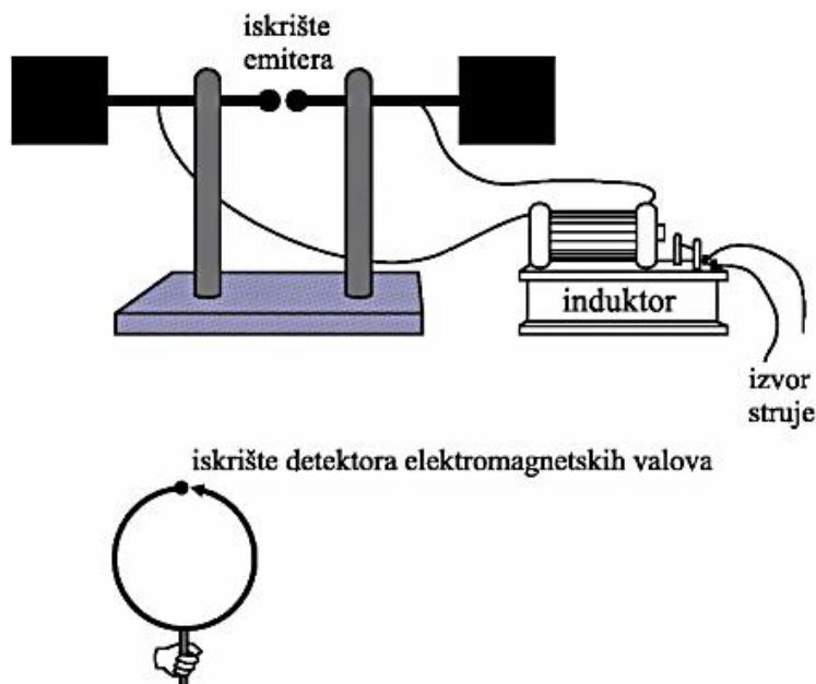
Slika 2.2. Herzov emiter s detektorom elektromagnetskih valova [6].
