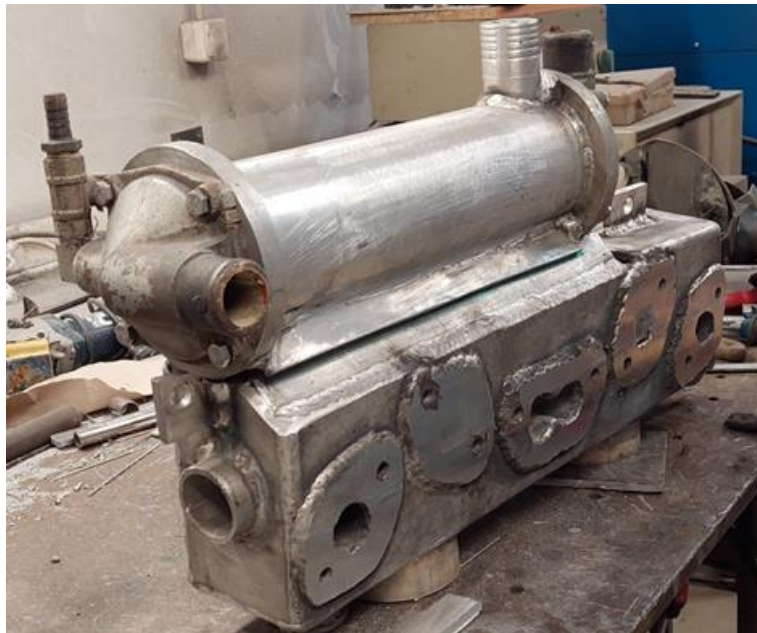
Slika 5.3 – Složeni komadi spremni za zavarivanje [12]
