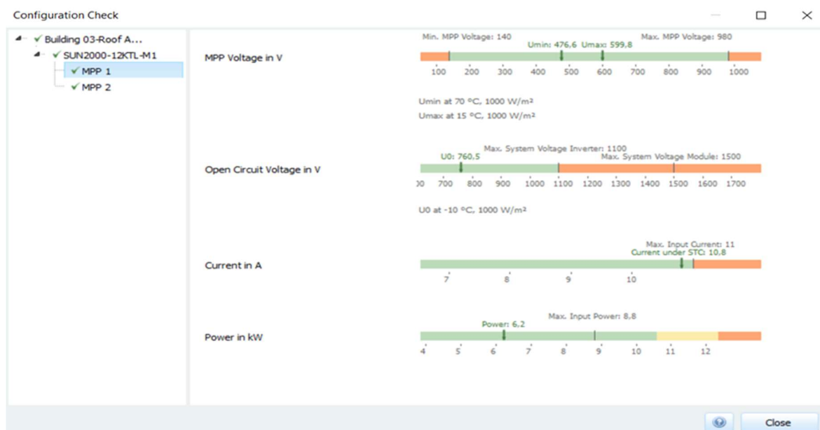
Slika 4.10. Prikaz parametara za MPP1 ulaz u izmjenjivač
