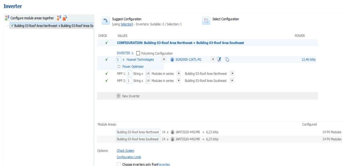
Slika 4.8. Prikaz odabira izmjenjivača HUAWEI SUN2000-12KTL-M1.
