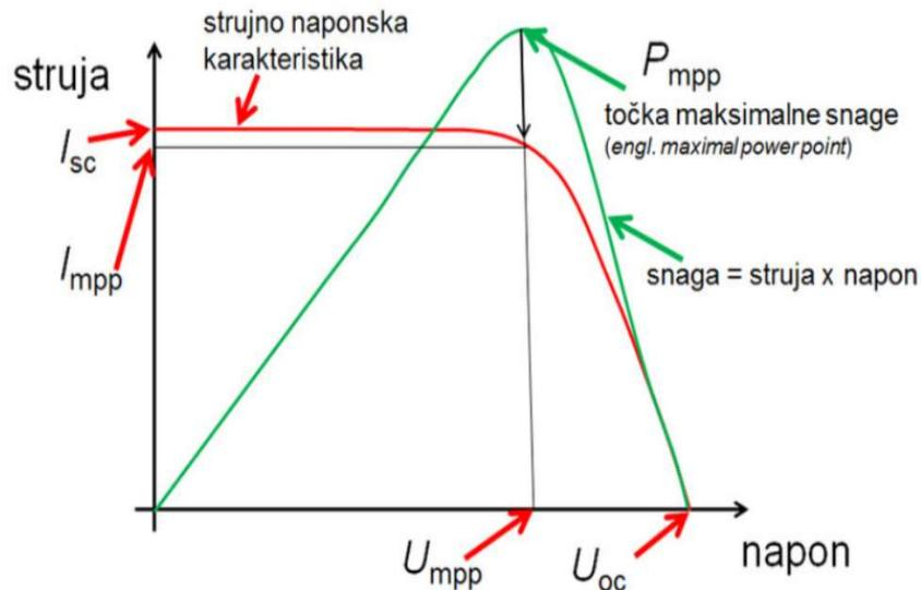
Slika 2.10. U-I karakteristika i karakteristika snage izmjenjivača [5]
