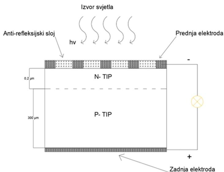
Slika 2.4. Fotonaponska ćelija [5]
