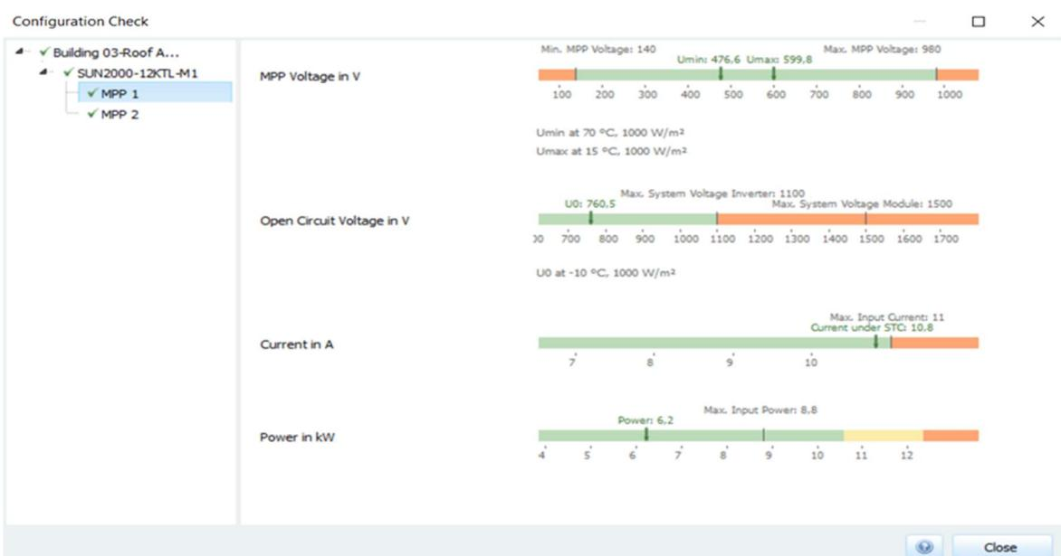
Slika 4.10. Prikaz parametara za MPP1 ulaz u izmjenjivač
