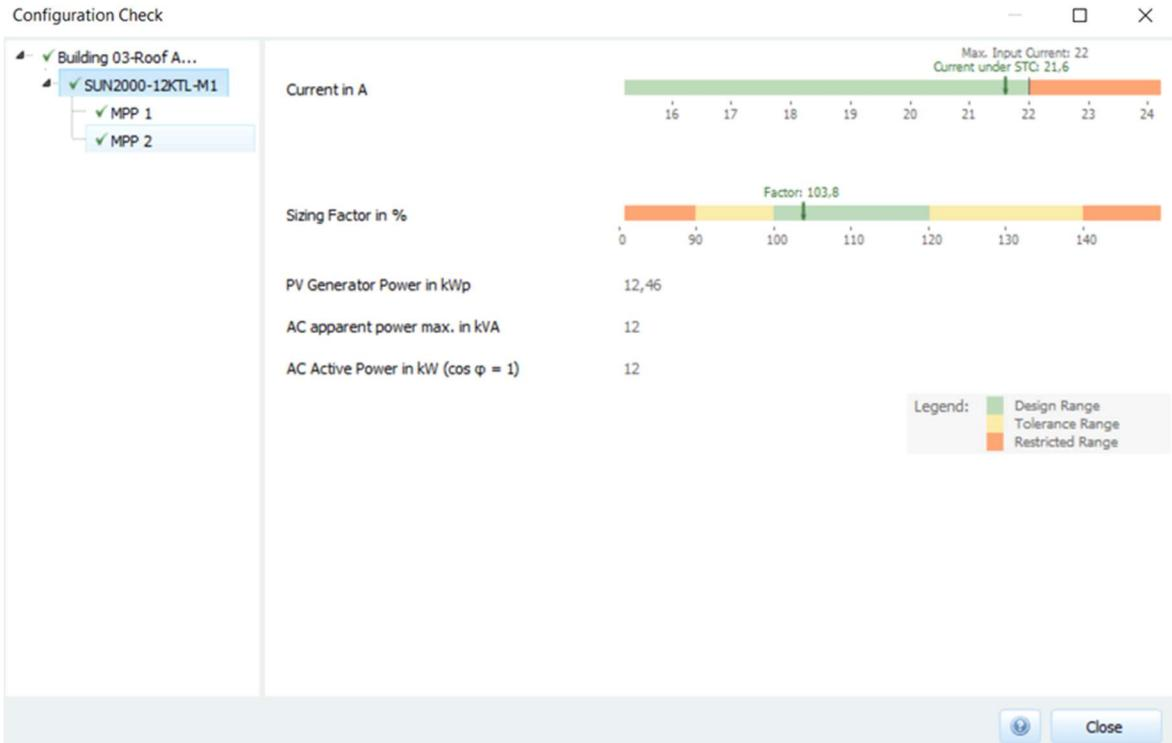
Slika 4.9. Parametri izmjenjivača HUAWEI SUN2000-12KTL-M1 sa spojenih 28 modula
