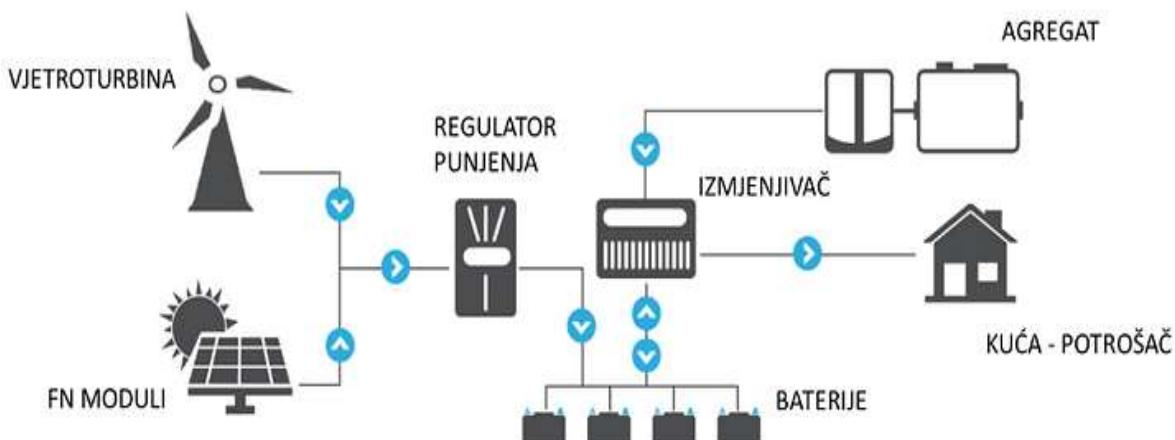
Slika 2.8. Hibridni fotonaponski sustav [4]
