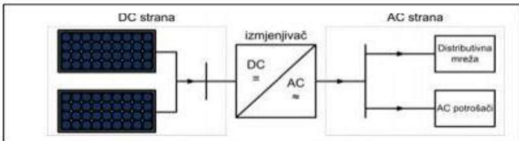
Slika 2.6. Mrežni (on-grid) fotonaponski sustav [4]
