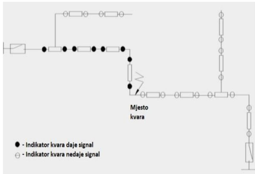
Slika 3.26. Shematski prikaz prorade indikatora prilikom kvara [2]
