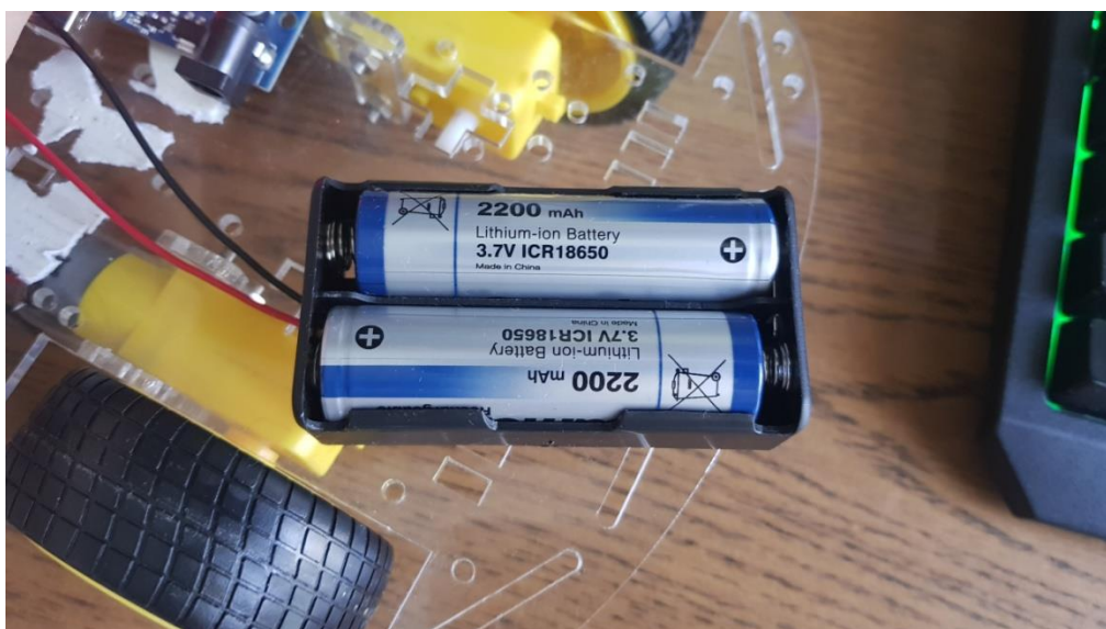
Slika 2.4.3. Li-ion baterije napajanja 2x 3.7V
