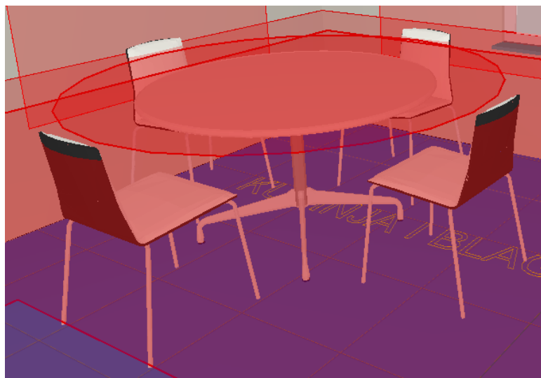
Slika 3.31. Mjerna površina na stolu u blagovaonici
