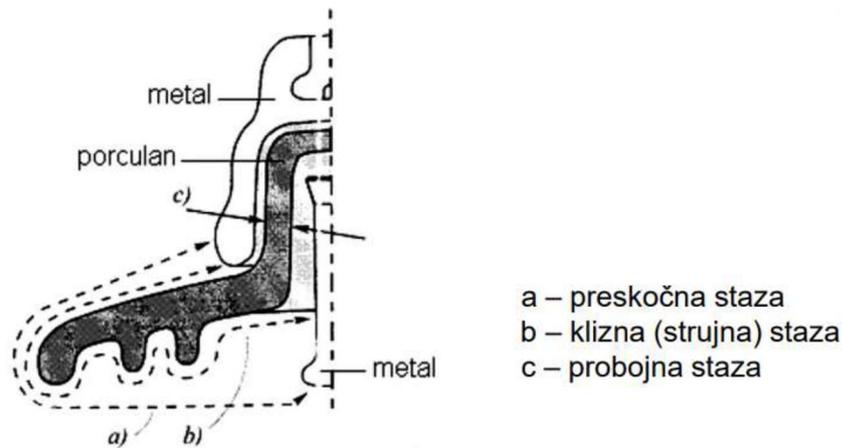
Slika 2.6. Dimenzioniranje izolatora [4]
