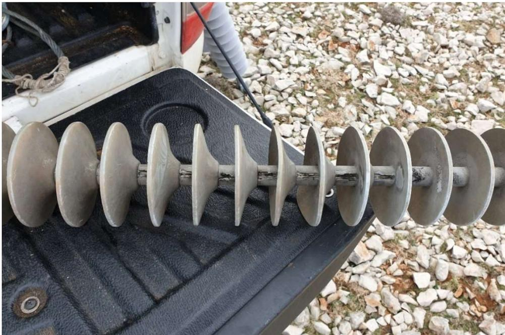
Slika 2.5. Proboj štapnog silikonskog izolatora
