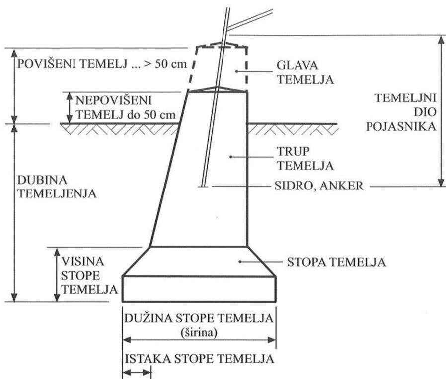
Slika 2.2. Dijelovi temelja [2]
