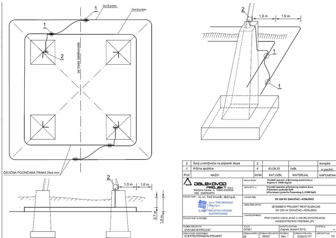
Slika 2.12. Prstenasti uzemljivač u obliku dvostrukog koncentričnog prstena [5]
