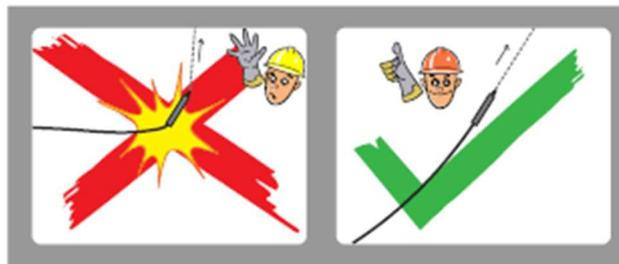
U tablici 4.3 dane su preporučene minimalne vrijednosti radnih promjera koloturnika i kola za namatanje vodiča strojeva za razvlačenje vodiča, ovisno o promjeru kompozitne jezgre ACCC vodiča, kako bi se izbjeglo oštećenje vodiča prilikom procesa razvlačenja vodiča.
