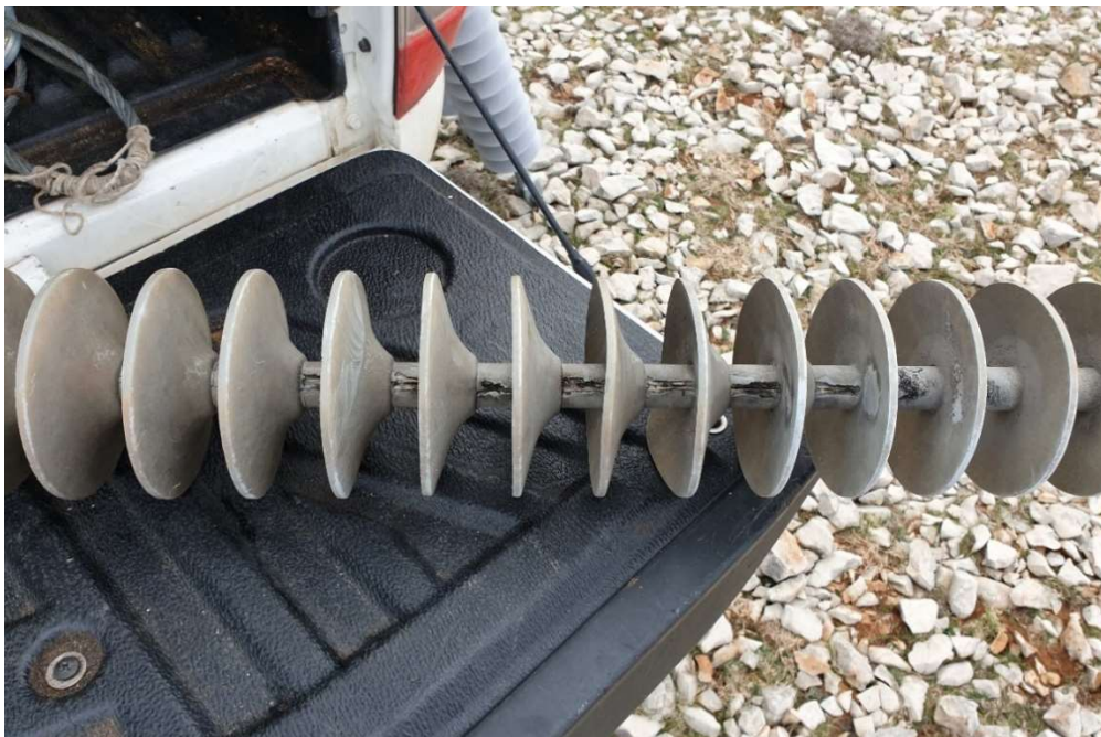
Slika 2.5. Proboj štapnog silikonskog izolatora
