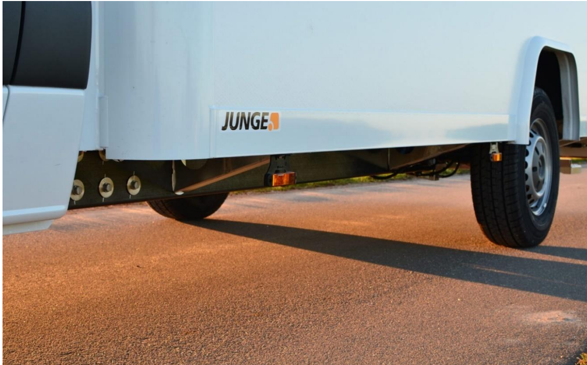
Slika 2.19 – Detalj dijela kompozitne šasije komercijalnog kombi vozila [26].
