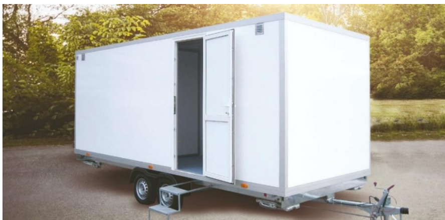
Slika 2.17 – Zatvoreni sanduk auto prikolice izrađen od kompozitnih sendvič panela (između dva sloja stakloplastike se nalazi toplinska izolacija) [24].
