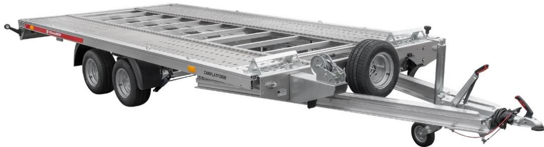
*Slika 2.15 – Prikolica „CAR PLATFORM FULL ALU 4521 S 2700 kg“, namijenjena prijevozu automobila. Nosiva konstrukcija prikolice je izrađena od aluminijskih legura [11].*
