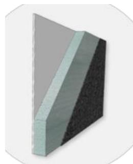
Slika 2.16 – Sendvič panel za izradu poda kamper prikolice se sastoji od protu kliznog sloja (GFRP), jezgre izrađene od ekspandiranog polistirena te glatkog vanjskog sloja (GFRP)[23].
