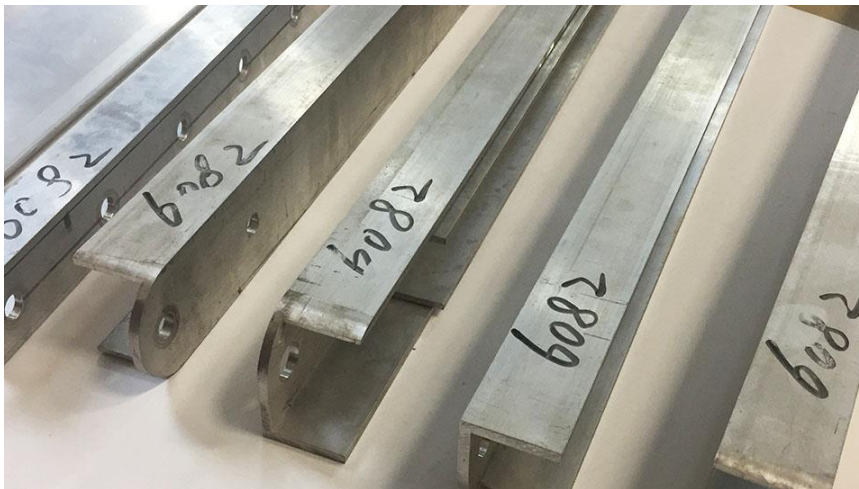
Slika 2.14 – Profili izrađeni od aluminijske legure 6082. Po Europskoj normi navedena legura ima oznaku EN AW-6082 [21].
