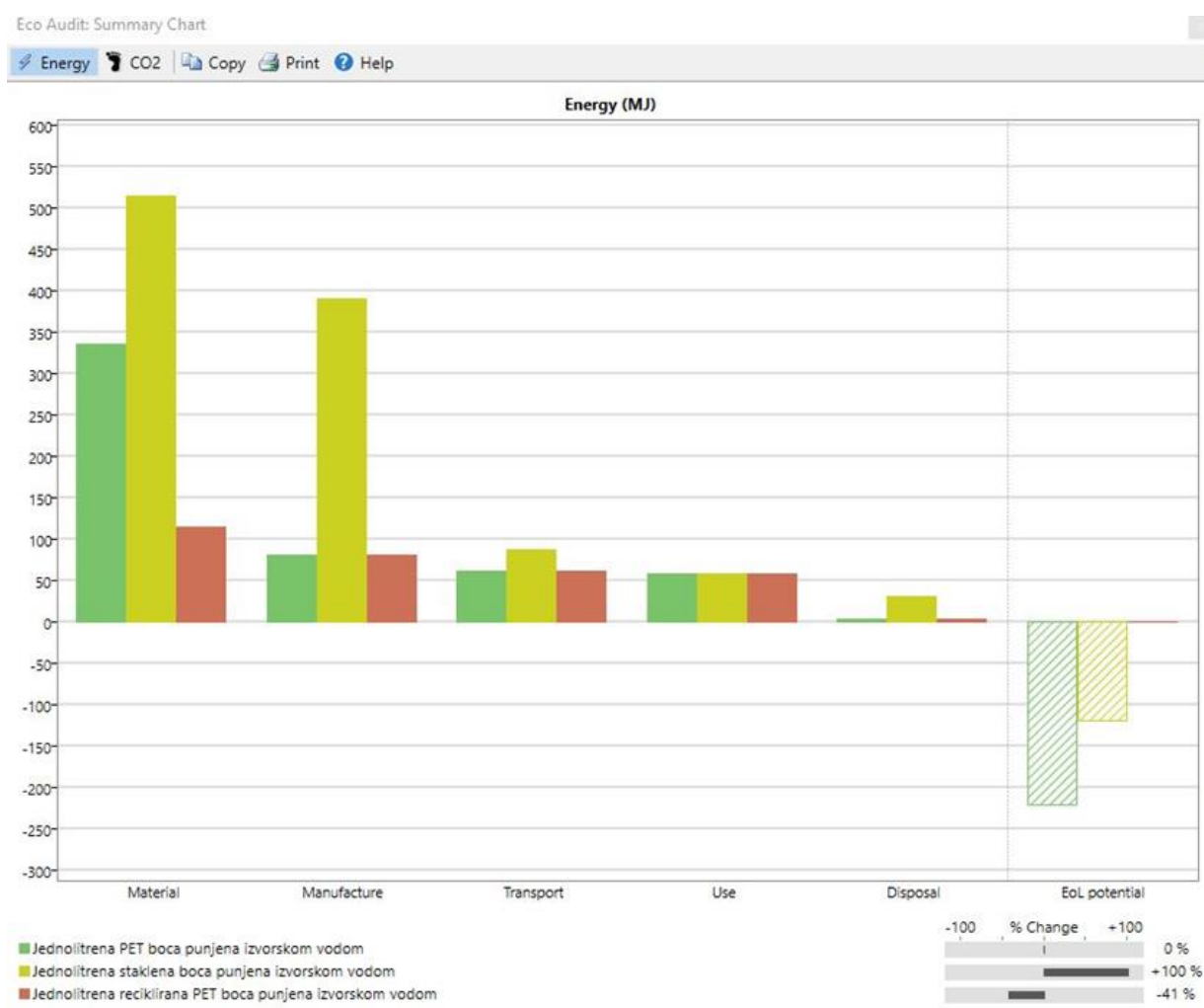
Slika 1.16 – Izlaz eko-revizije usporedbe 100 PET boca, 100 staklenih boca i 100 recikliranih PET boca (smeđe područje), u pogledu utroška energije po životnim fazama [9].
