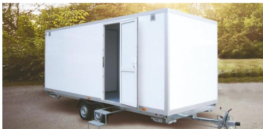
Slika 2.17 – Zatvoren sanduk auto prikolice izrađen od kompozitnih sendvič panela (između dva sloja stakloplastike se nalazi toplinska izolacija) [24].
