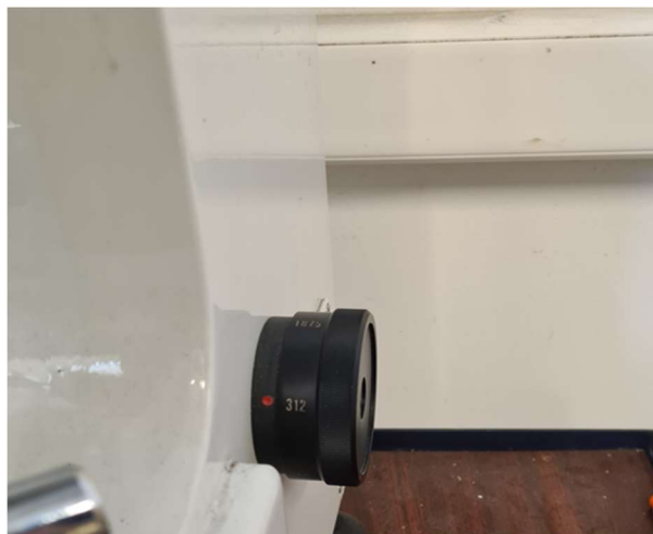
Slika 5. 4 – Izbor sile utiskivanja penetratora (30kp)
