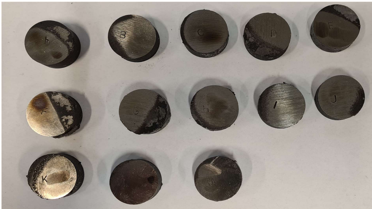
Slika 5. 1– Toplinski obrađene i označene epruvete pripremljene za mjerenje tvrdoće
