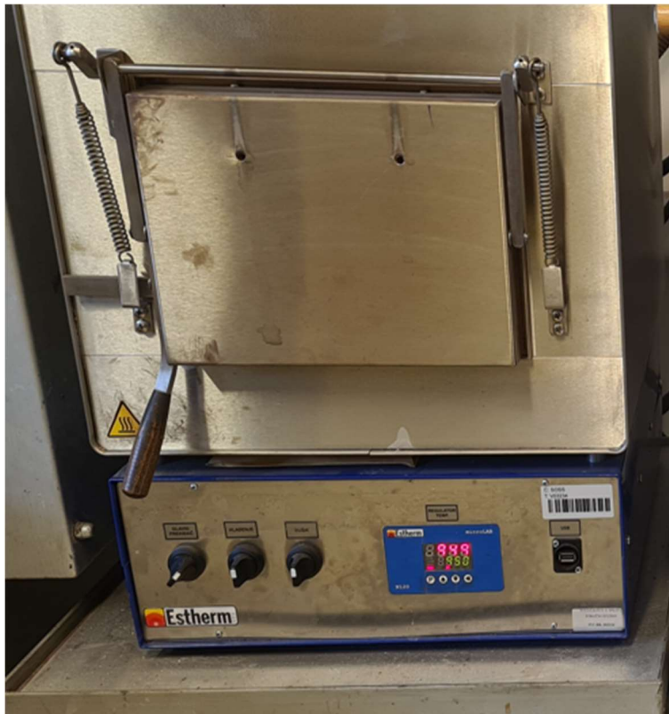
Slika 3. 3- Peć s prikazanom temperaturom austenitizacije 950°C
