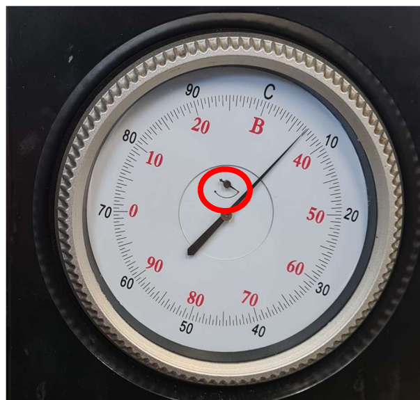
Slika 5. 6 – Pozicioniranje male kazaljke u pravilan položaj
