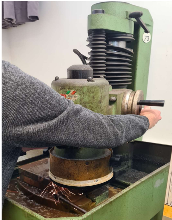
Slika 3. 4 – Brušenje epruveta na planskoj brusilici
