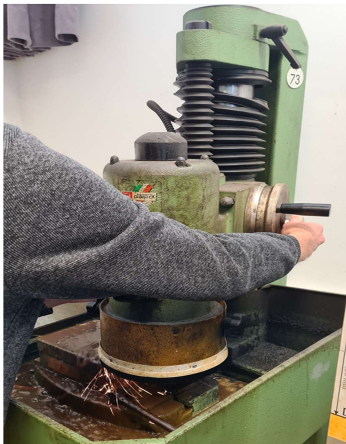
Slika 3. 4 – Brušenje epruveta na planskoj brusilici
