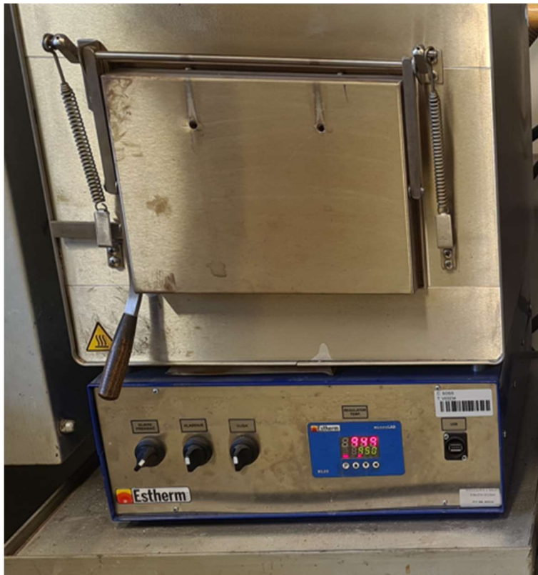
Slika 3. 3- Peć s prikazanom temperaturom austenitizacije 950°C
