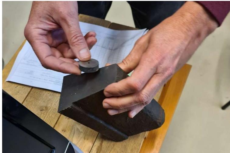
*Slika 3. 1- Odljevak žilavog lijeva za izradu epruveta*
