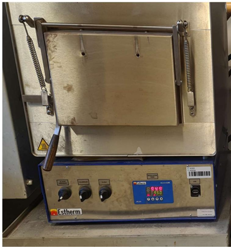
*Slika 3. 3- Peć s prikazanom temperaturom austenitizacije 950°C*
