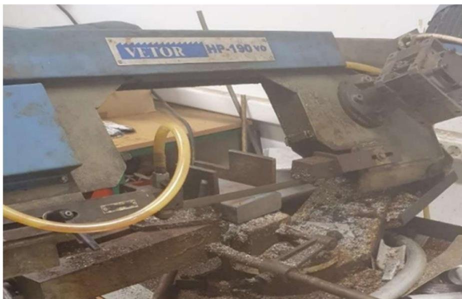
Slika 3. 8 – Rezanje sirovca na tračnoj pili
