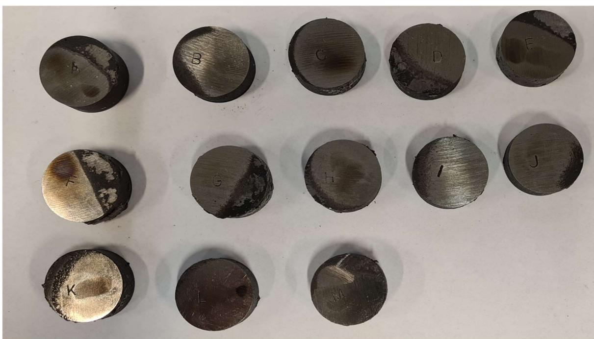
Slika 5. 1– Toplinski obrađene i označene epruvete pripremljene za mjerjenje tvrdoće
