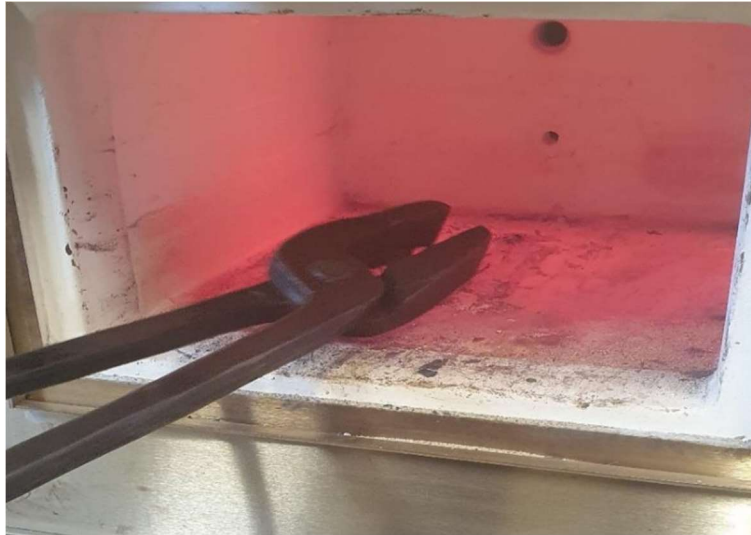
Slika 5. 2 – Umetanje epruvete u peć za austenitizaciju
