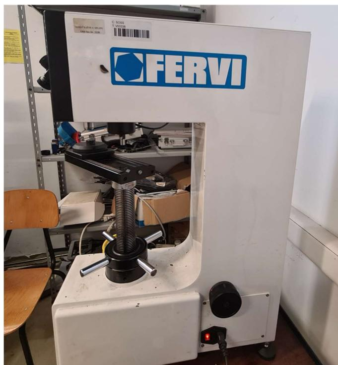
*Slika 3. 5 – Uredaj za ispitivanje tvrdoće epruveta*
