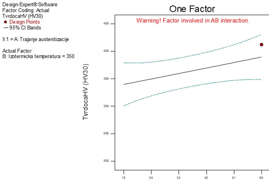
Slika 6. 7 - Utjecaj trajanja austenitizacije na tvrdoču uz konstantnu temperaturu izotermičke kupke od 350 °C
