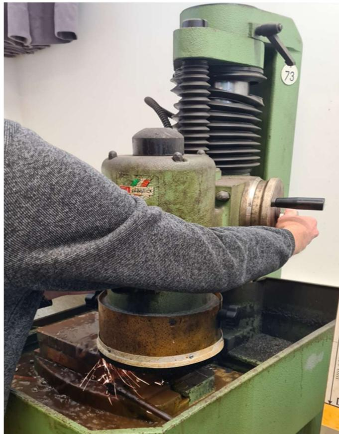
*Slika 3. 4 – Brušenje epruveta na planskoj brusilici*
