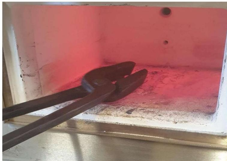
Slika 5. 2 – Umetanje epruvete u peć za austenitizaciju
