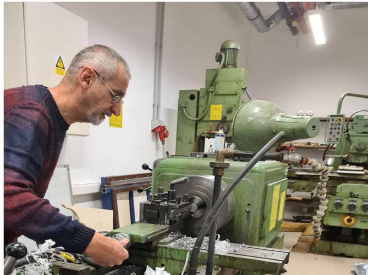
Slika 3. 9 – Obrada epruveta na tokarilici
