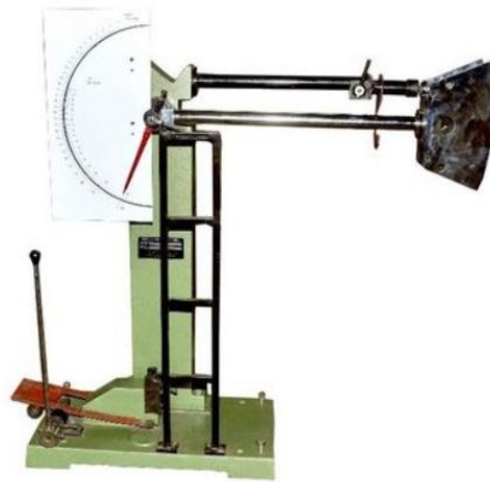
Slika 1.3 - Charpy uređaj za ispitivanje žilavosti [5]
