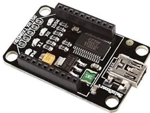
Slika 4.6 SainSmart XBee USB Explorer
