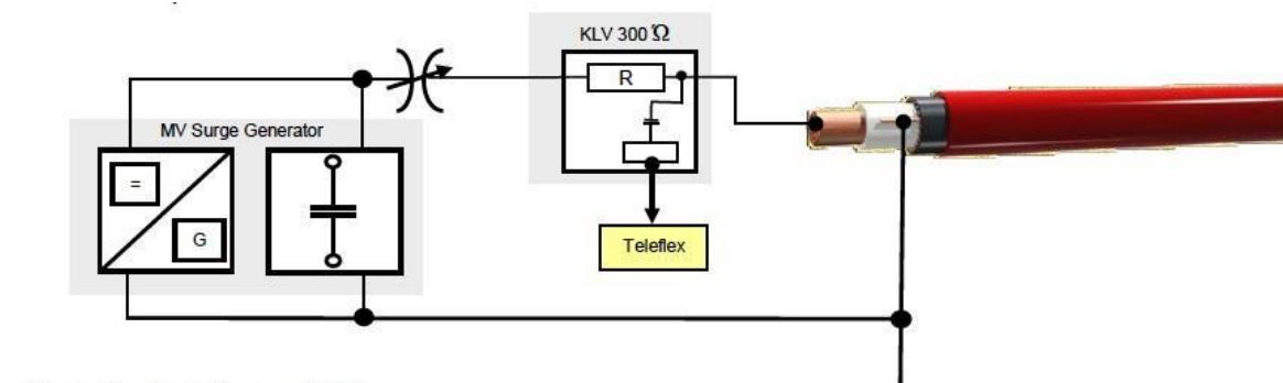
Slika 4.4. pasivno-otporna metoda - shema spoja
