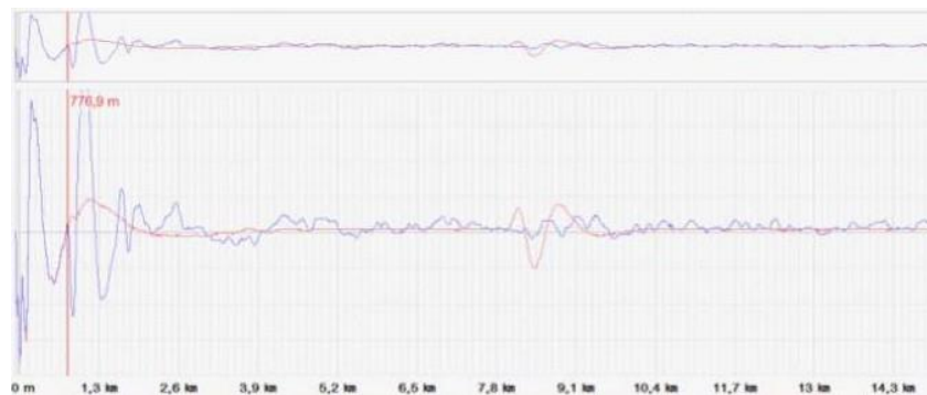
Slika 4.3. Metoda dvostrukog udara na 8 km kabl
