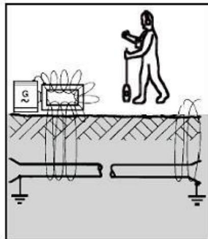
Slika 5.3. Induktivna veza generatora i kabela preko antene
