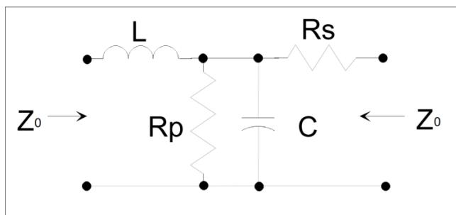
Slika 3.1. Ekvivalentna shema dijela kabela od 1 m
