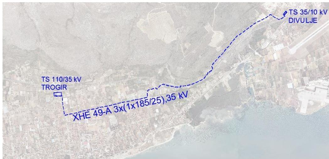
Slika 7.2. Trasa ispitivanog kabela
