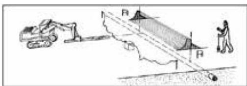
Slika 5.7. Položaj zvučno frekvencijskog generatora u odnosu na metalne šiljke
