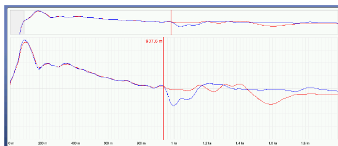
Slika 4.8. Referentna krivulja i krivulja kvara
