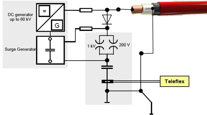
Slika 4.7. Shema spoja metode vrlo visokog napona
