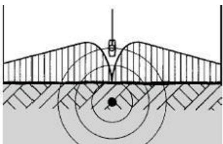
Slika 5.5. Detekcija minimalnog signala pomoću zavojnice
