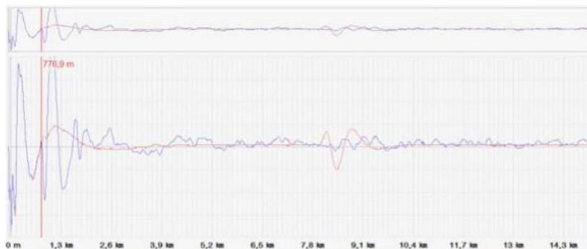
Slika 4.3. Metoda dvostrukog udara na 8 km kabelu
