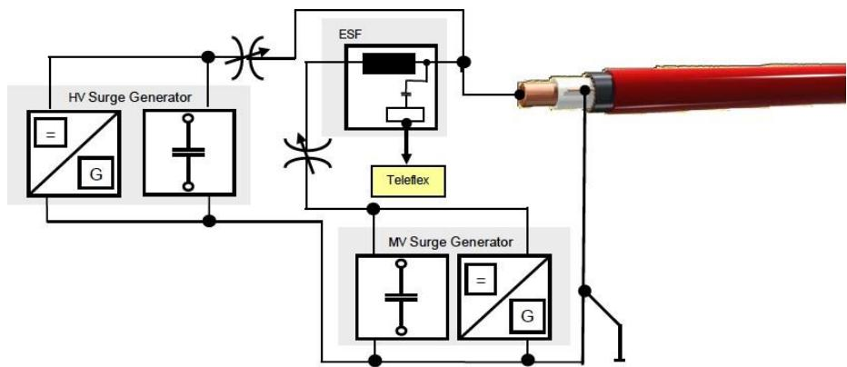
Slika 4.2. Shema spoja za metodu dvostrukog udara
