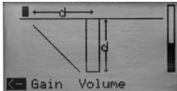
Slika 7 Jednakokračni trokut za računanje dubine kabela
