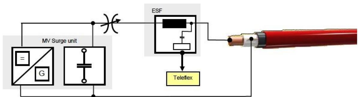
Slika 4.1. Shema spoja ARM induktivne metode
