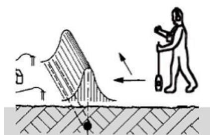
Slika 5.8. Oblik signala iznad trase kabela
