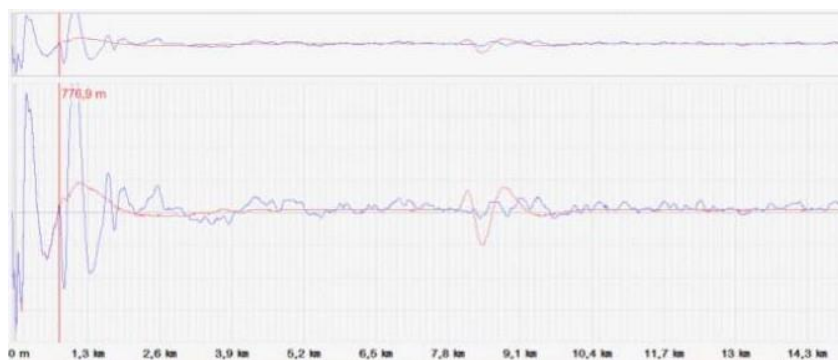
Slika 4.3. Metoda dvostrukog udara na 8 km kabl
