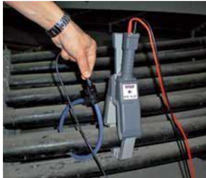
Slika 5.15. Fleksibilna strujna kliješta i obična strujna kliješta
