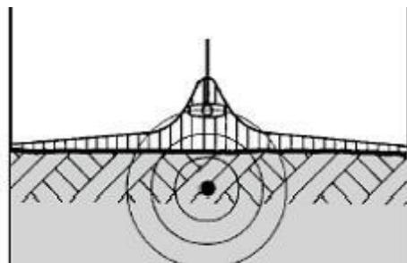
Slika 5.4. Detekcija maksimalnog signala pomoću zavojnice
