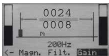
Slika 9 Udaljenost kvara od jednog i drugog zdenca
