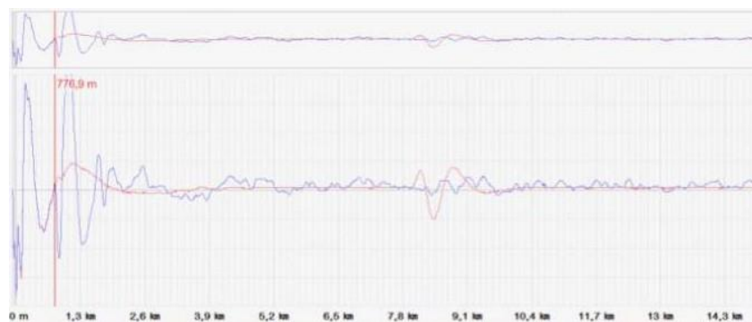
Slika 4.3. Metoda dvostrukog udara na 8 km kabelu
