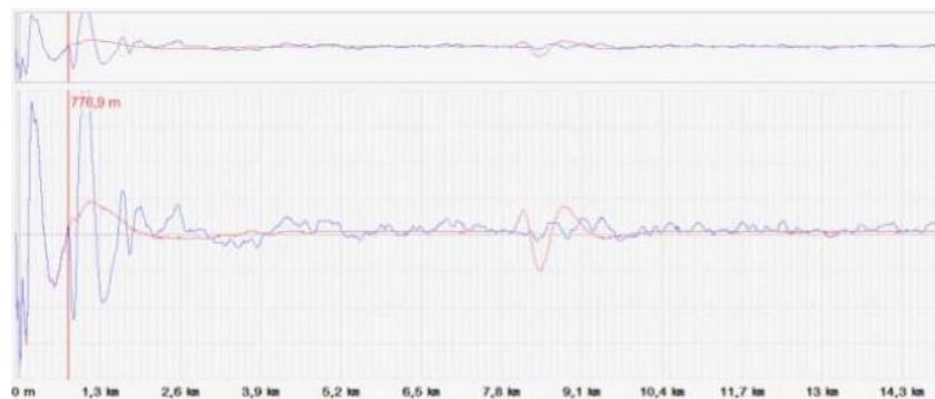
Slika 4.3. Metoda dvostrukog udara na 8 km kabelu
