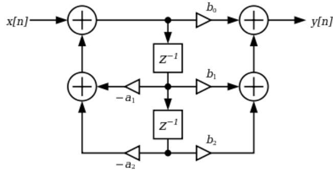
Slika 10. Blok shema IIR filtra [6]
