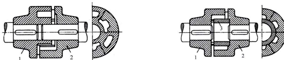
Slika 3.27 - Kandžasta dvodijelna spojka [19] Slika 3.28 - Kandžasta trodijelna spojka[20]
