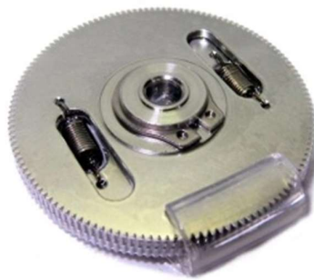
Slika 3.9 - Anuliranje zračnosti pomoću dodatnog zupčanika [13]
