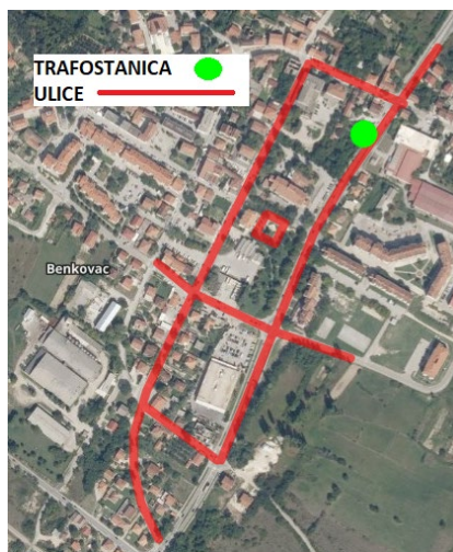
Slika 4.7.1. Područje napajanja trafostanice Benkovac 2
