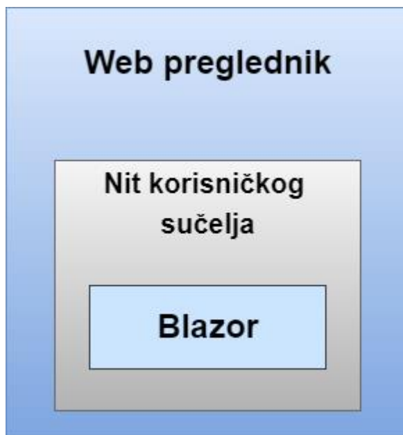
Slika 5 - Arhitektura Blazor WebAssembly
