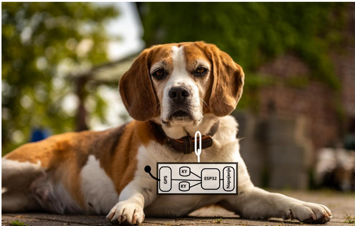
Slika 8 - Primjer prototipa hardvera na ljubimcu
