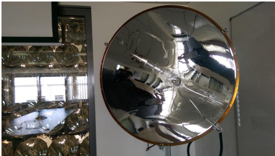
Slika 2.9 Eliptički reflektor s ksenonskim kratkim lučnim svjetiljkama (DLR lokalitet, Jülich)
