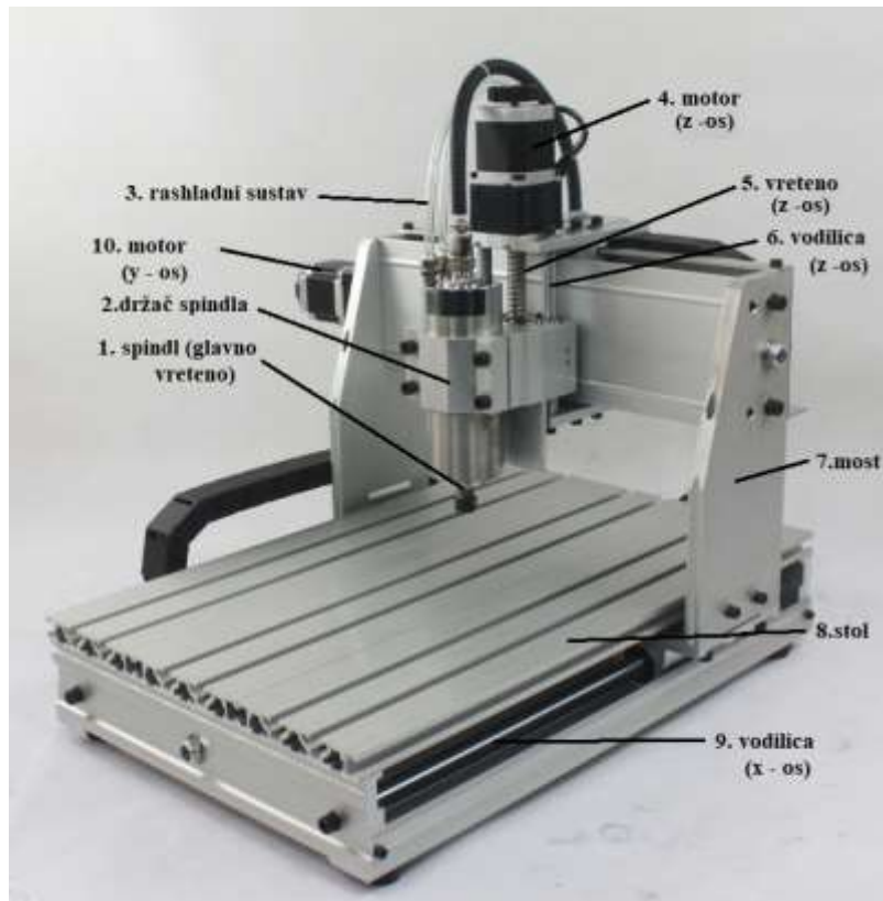
Slika 1.6 - Osnovni funkcijski dijelovi CNC glodalice [8]
