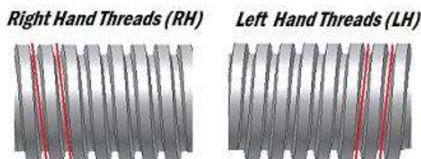
Slika 2.6 - Smjer navoja na trapeznim vretenima [19]
