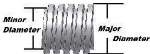
Slika 2.5 - Vanjski i unutarnji promjer trapeznog vretena [19]
