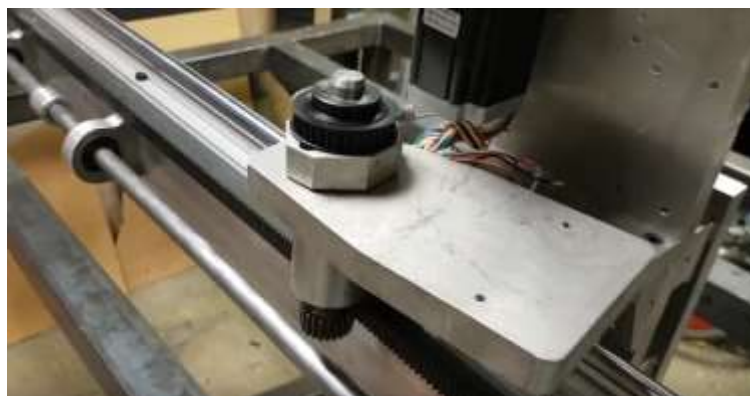
Slika 2.13 - Zupčasta letva na CNC stroju
