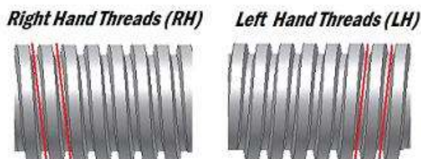
Slika 2.6 - Smjer navoja na trapeznim vretenima [19]
