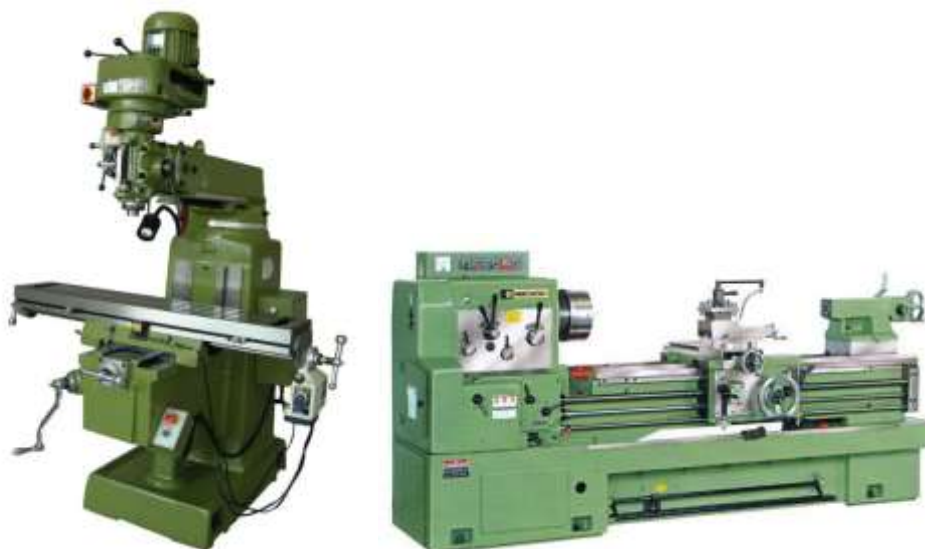
Slika 1.2 - Ručno upravljana glodalica; Ručno upravljana tokarilica [2] [3]
