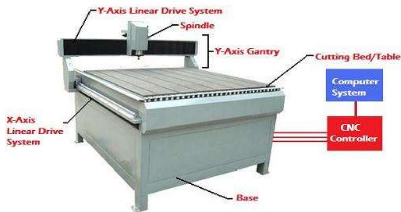
Slika 1.5 - Primjer 3-osne CNC glodalice [7]
