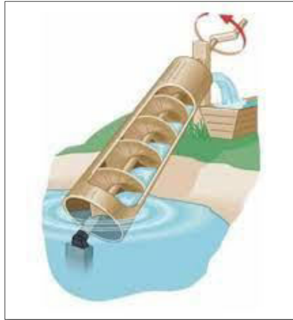
Slika 1.2– Korištenje Arhimedovog vijka [2]
