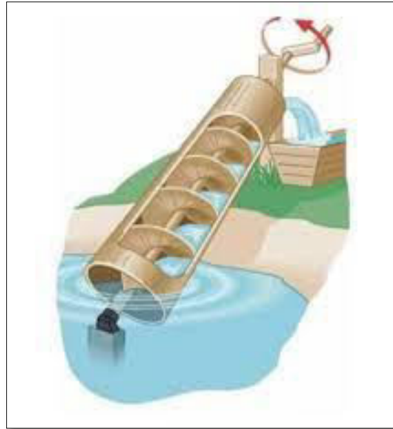
Slika 1.2– Korištenje Arhimedovog vijka [2]
