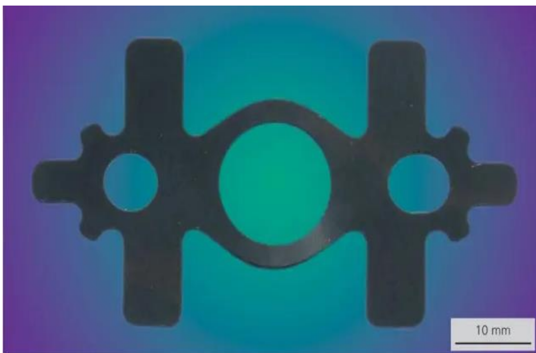
Slika 28. Primjer laserskog rezanja, dio od nehrđajućeg čelika, izrezan unutar 195 ms od lima debljine 0,1 mm sa snagom lasera od 1000 W. [15]
