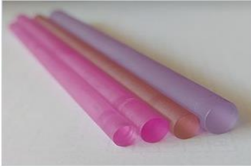
Slika 10. Laserske šipke (s lijeva na desno): Rubin, Aleksandrit, Er:YAG, Nd:YAP [7]
