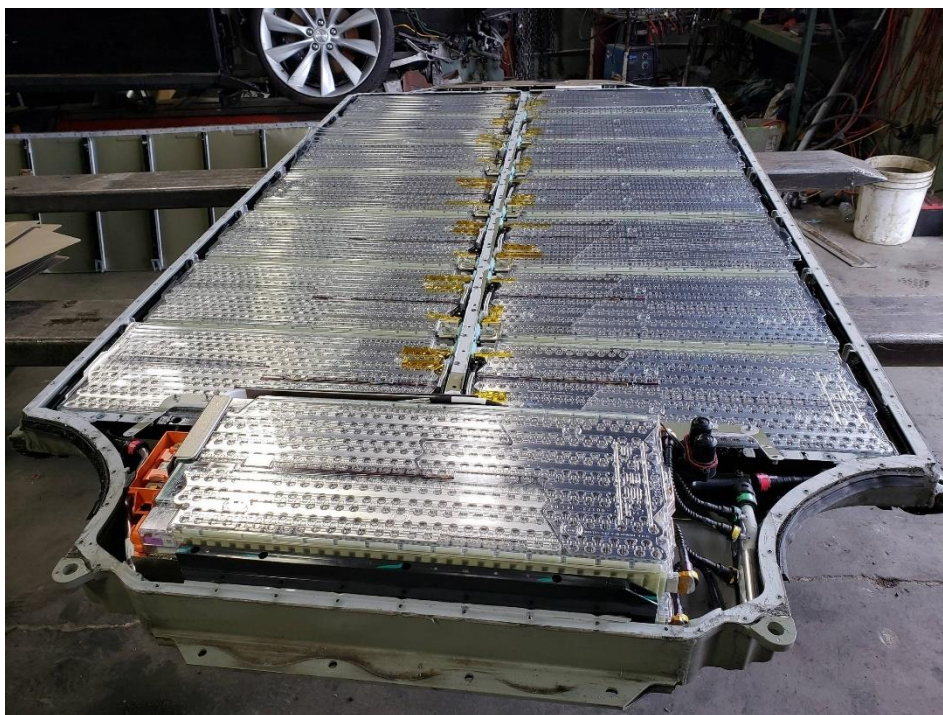
Slika 3.20. Baterijski paket u podu automobila [10]
