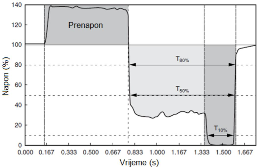
Slika 3.3. Karakterizacija određenog napona efektivne vrijednosti mjerjenjem odstupanja faze[1]
