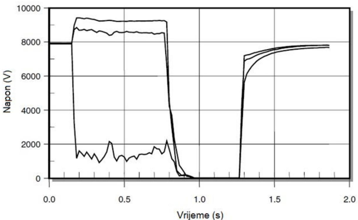
Slika 3.1. Prekid napona uslijed naponskog propada jedne faze [1]
