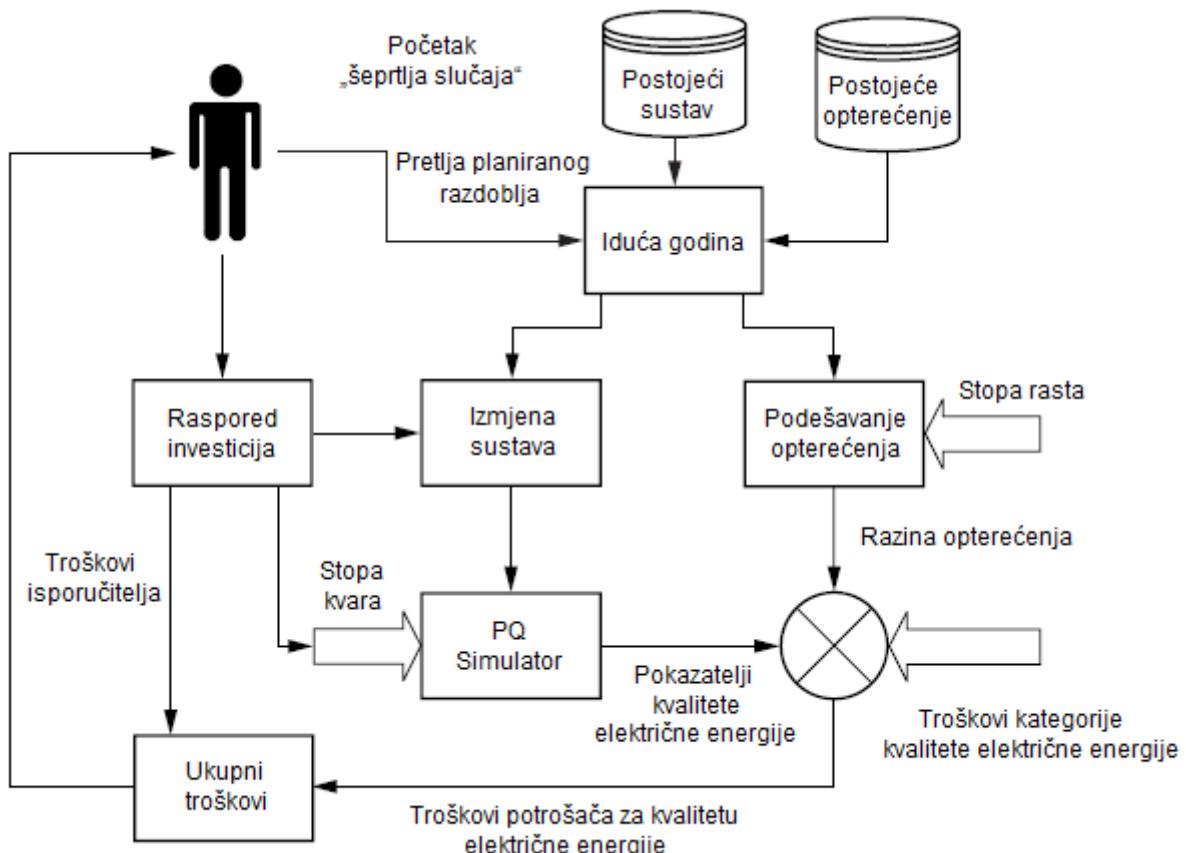
Slika 5.2. Proces planiranja kvalitete električne energije [1]
