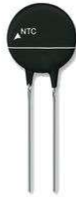
Slika 3.5. Česti izgled termistora [6]
