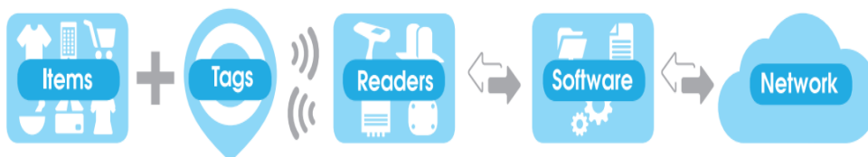
Slika 9. RAIN RFID princip rada
